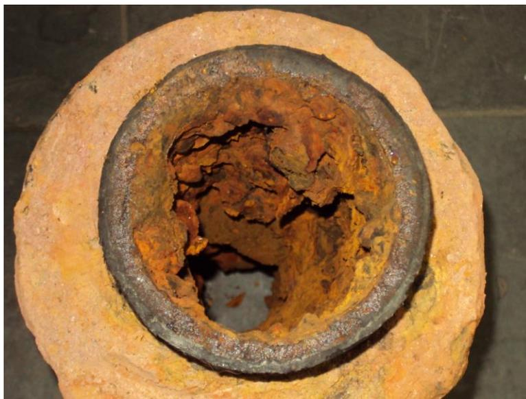
Figura 3.1: Amostra de tubo de ferro fundido sem revestimento, instalado em 1963, no setor de abastecimento Cachoeirinha, retirado para análise de estado em 2009.
