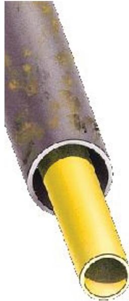
Figura 3.7: Técnica de Inserção de nova tubulação
