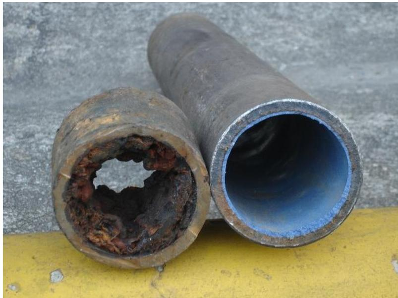
Figura 3.5: Tubo rehabilitado por aplicação de resina epóxi
