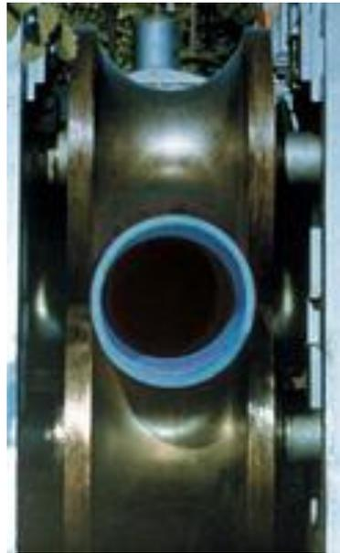
Figura 3.8: Redução diametral através da passagem por rolos ou ferramentas
