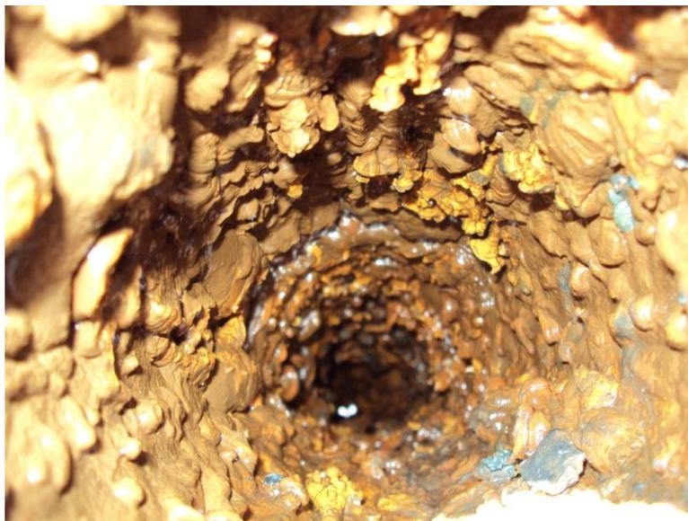
Figura 3.2: Detalhe do interior da amostra de tubo de ferro fundido sem revestimento instalado em 1963, no setor de abastecimento Cachoeirinha, retirado para análise de estado em 2009.
