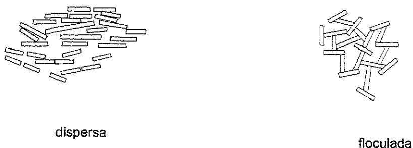
FIGURA 3.7 - Modelos estruturais básicos: representação esquemática da orientação de partículas FONTE: adaptado de LEONARDS, 1962
