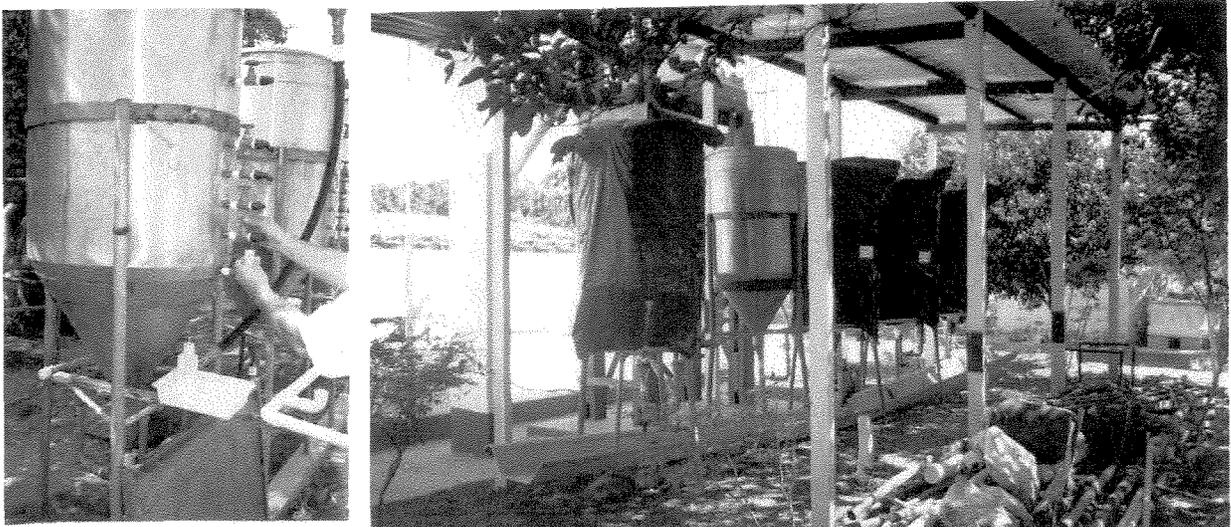
**FIGURA 4.13** Tomada laterais **FIGURA 4.14** Filtros revestidos com isolante externo
