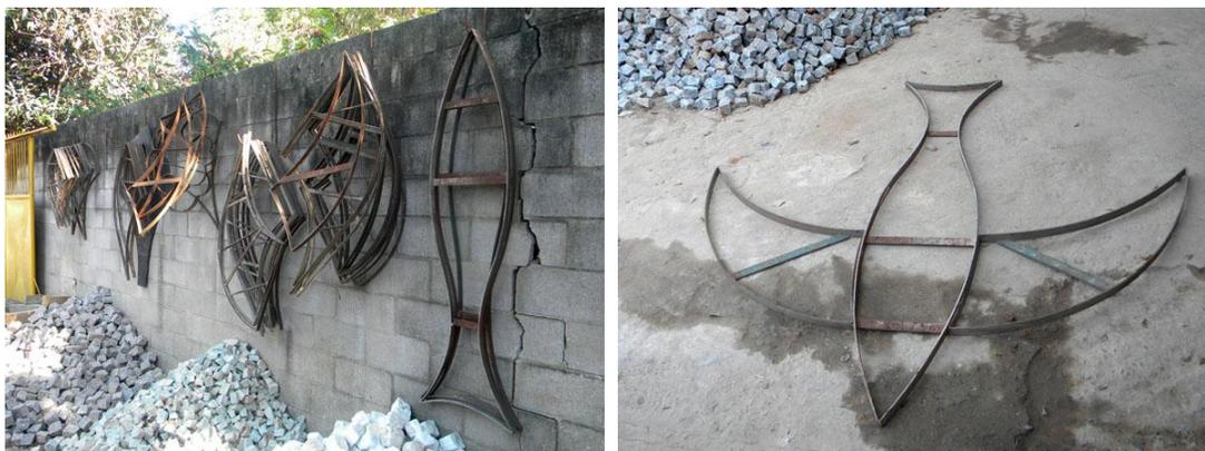
**Figura 135. A:** Coleção de formas metálicas da empresa Pedramista, Campinas. **B:** Três formas para a *andorinha*. Campinas, SP. Formas/moldes/gabaritos. Fotografias da autora
