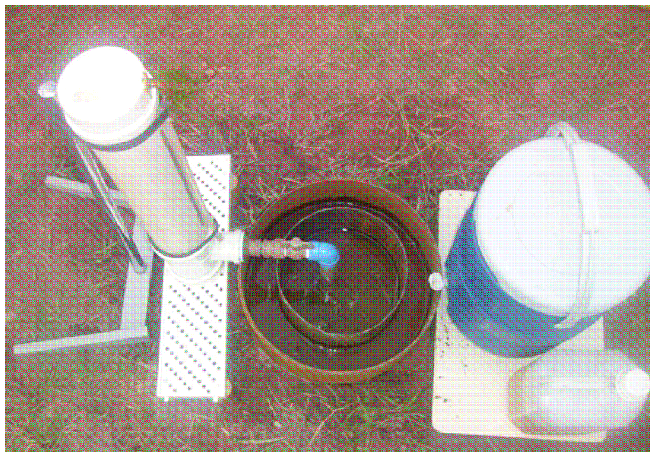
Figura 3.26: Vista geral do infiltrômetro utilizado. Fonte: Mendes (2008)
