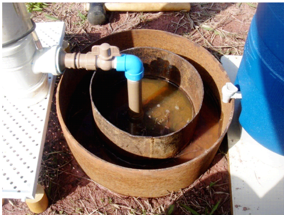
Figura 3.29: Teste de infiltração em execução Fonte: Mendes (2008).
