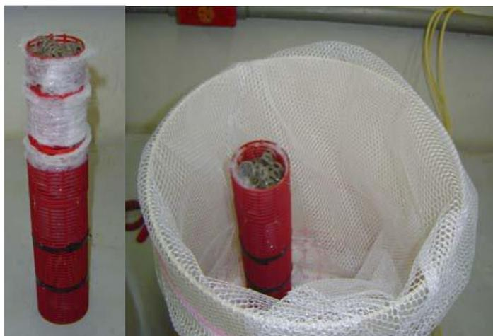
**Figura 4.3: Cestos para coleta de anéis de Raschig ao longo do reator (CASTAGNATO, 2006).**
