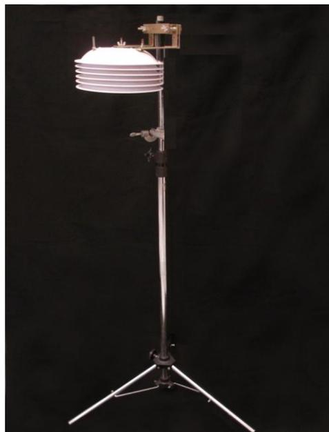
**Figura 4.8** – Registrador de temperatura e umidade, com protetor, para medições externas.
