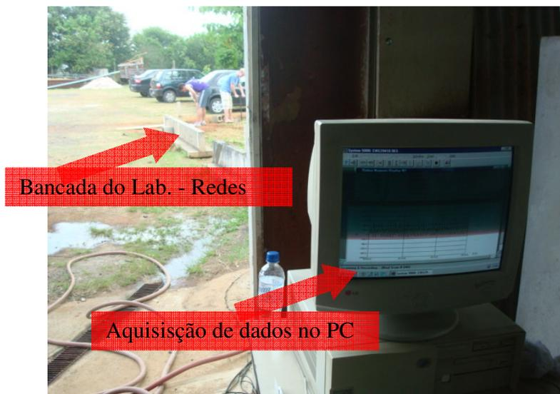
Figura A.7 - Vista do sistema de dados switch-PC interligado a parte externa do Laboratório nos extensômetros das tubulação de PVC.
