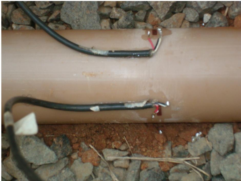
Figura A.5 - Vista dos dois extensômetros fixados na parede externa da tubulação de PVC.
