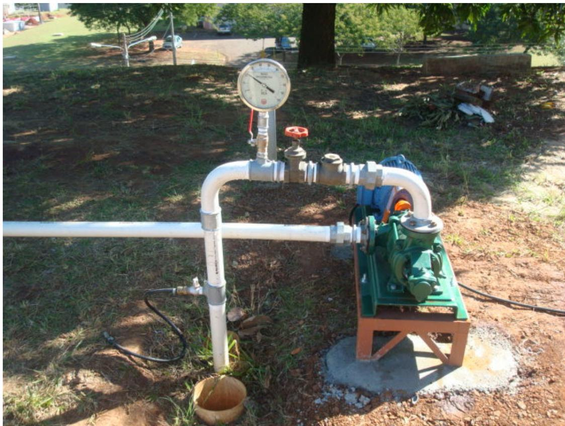
Figura B.4 - Manômetro utilizado nos ensaios de laboratório no segundo arranjo de montagem.
