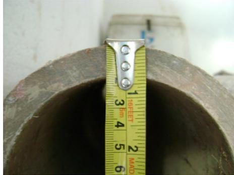
Figura 3.22 – Diâmetro e espessura de uma tubulação de Cimento Amianto de 125mm – Fonte: Sabesp
