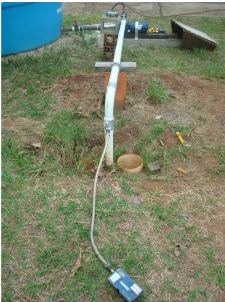
Figura B.2 - Registrador de pressão instalado na rede do laboratório.
