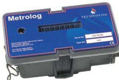
Figura B.1 - registrador de pressão utilizado nos ensaios de laboratório.
