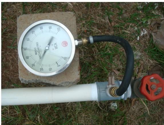
Figura B.3 - Manômetro para monitoramento operacional de pressão utilizado nos ensaios de laboratório.
