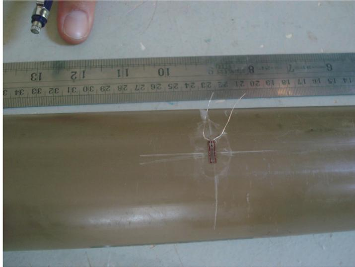
Figura 4.17 – Extensômetro fixado na parede externa da tubulação
