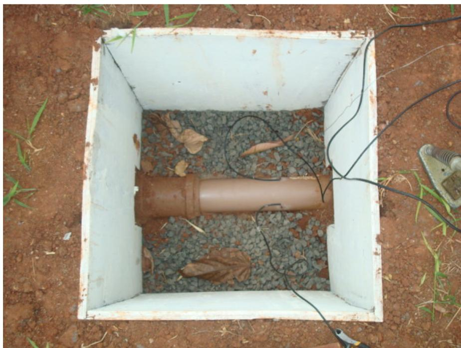
Figura 4.9 – Ponto de monitoramento de deformação (strain gage) do tubo PVC da bancada de ensaios
