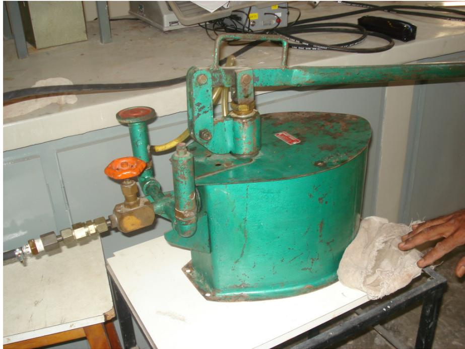
Figura 4.14 – Bomba pressurizadora para ensaio de tensão deformação
