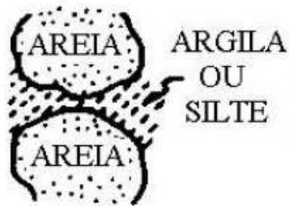
*Figura 2.13. Arranjo estrutural devido a vínculos de argila resultantes de corridas de lama (Dudley, 1970).*
