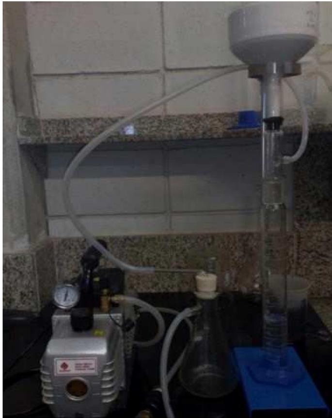
**Figura 20 – Foto mostrando o esquema de montagem do sistema de filtração conforme (ADAMS, 1981 GRANDIN, 1992)**
