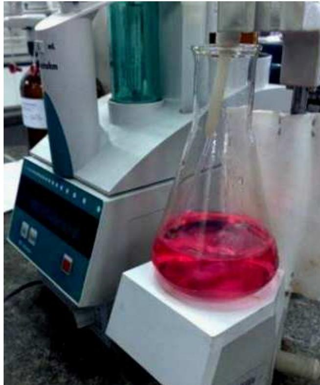
**Figura 21 – Foto do titulador utilizado na determinação do cloro pelo método DPD**
