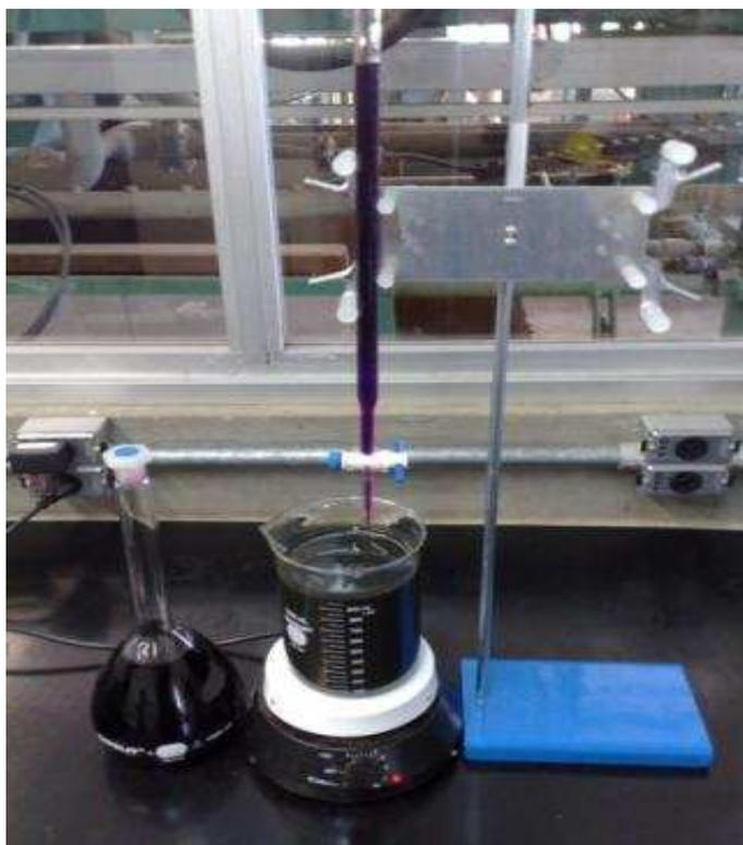
**Figura 24 – Foto da aparelhagem utilizada para adição de permanganato de potássio.**
