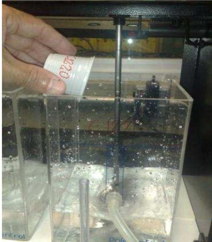
**Figura 19 – Foto da adição de polímero em pó em uma cuba de “jar-test”**
