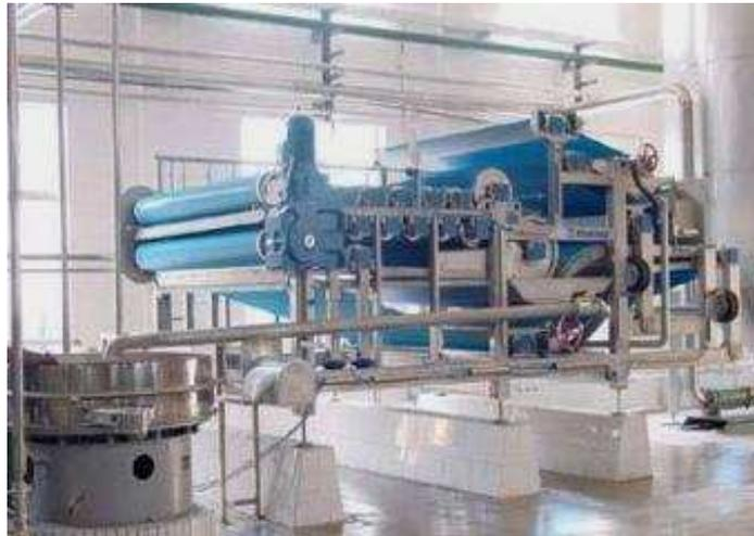
**Figura 8 – Foto filtro prensa de esteiras Fonte: (FLOTTWEG SEPARATION)**
