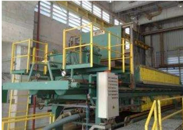
**Figura 9 – Foto filtro prensa de placas na ETA de Taiapuêba Fonte: (Sabesp)**
