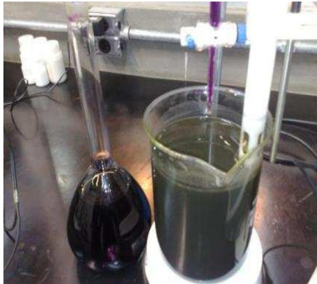
**Figura 25 – Foto da oxidação do lodo com adição de permanganato de potássio**
