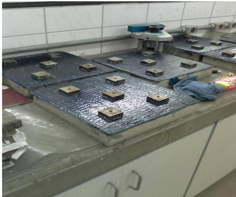
Figura 4.18 - Amostras prontas para o ensaio.
