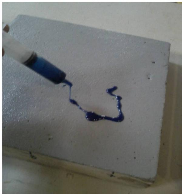
Figura 4.15 – Ilustração da resina de impregnação – Saturante.
