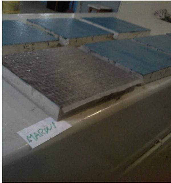
Figura 4.16 – Manta na placa de concreto.
