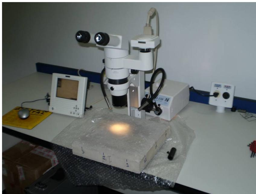
Figura 4.12 – Estereomicroscópio SMZ 800.
