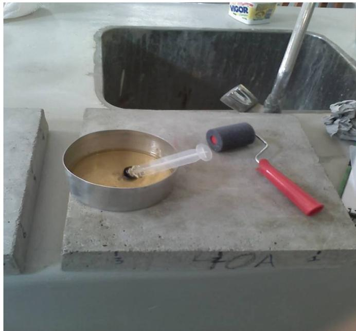
Figura 4.13 – Materiais para aplicação do adesivo estrutural.
