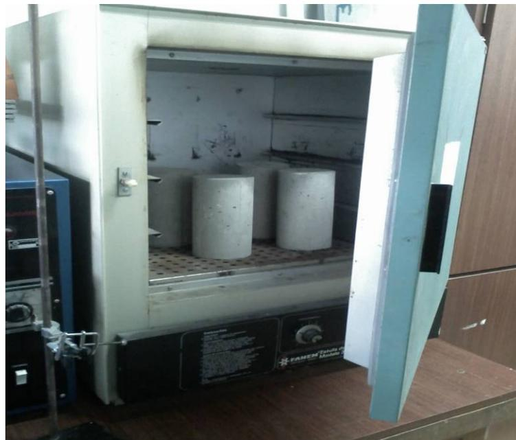
Figura 4.5 – Amostras sendo submetidas em estufa.
