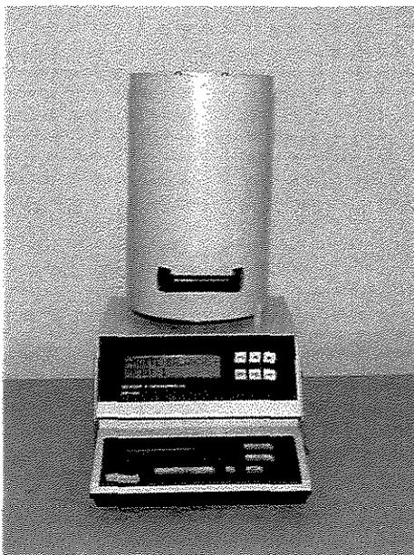
Figura 4.2 - Secador Infravermelho IRP-150
