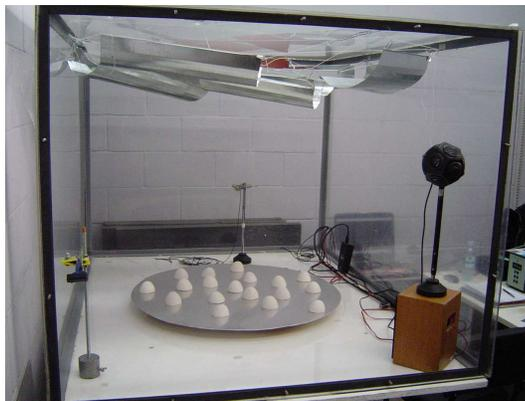
*Figura 5.3. Aspecto final da câmara reverberante em escala com equipamentos para medição do coeficiente de espalhamento.*
