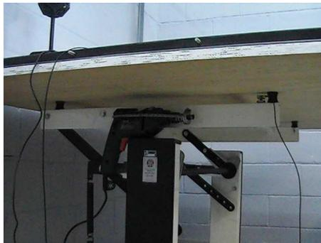
*Figura A.3. Detalhe do acoplamento da fonte de vibração (furadeira) na estrutura de apoio.*
