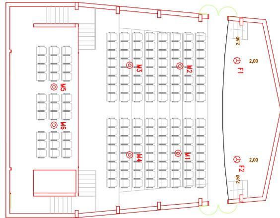
*Figura 5.12. Pontos de microfones e fontes da medição realizada no auditório da ADUNICAMP.*
