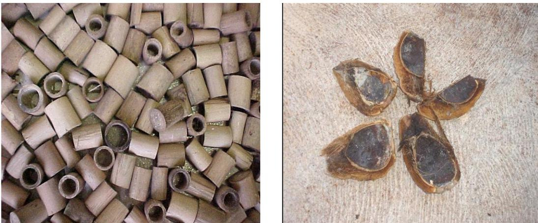
**Figura 4.7:** Detalhe dos materiais utilizados como meio suporte – os anéis de bambu e as cascas de coco verde.
