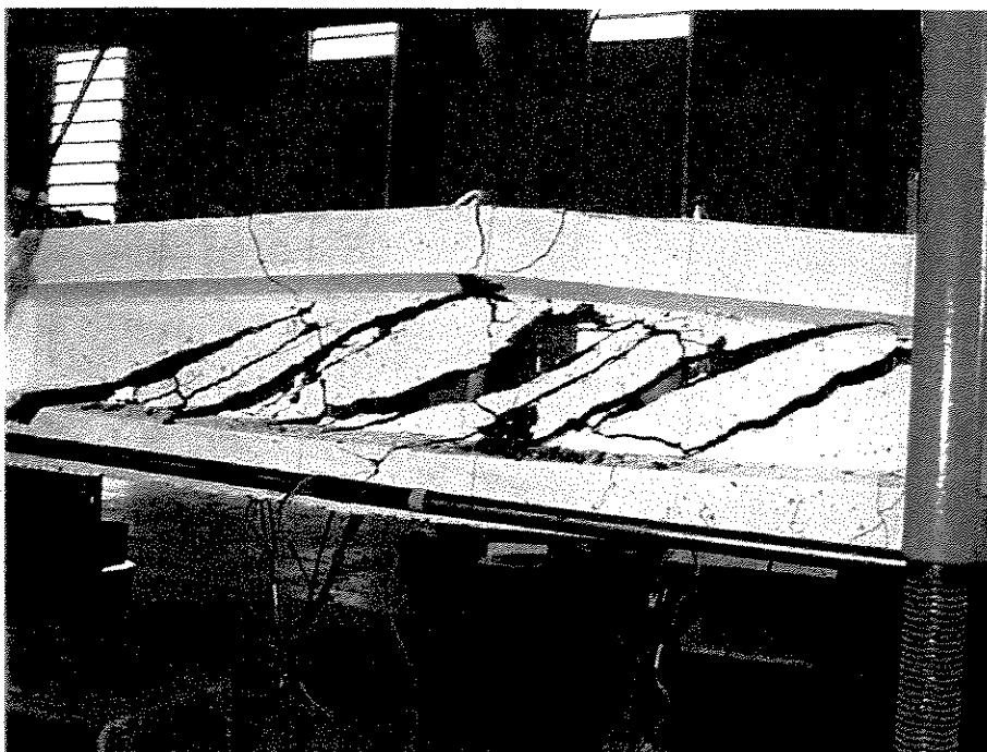
FIGURA 5.05 DETALHES DA VIGA I80-4-22-E28 ROMPIDA.
