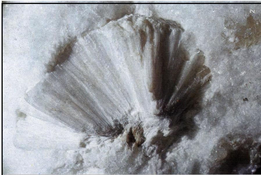
**Figura 4.18 – Micrografia da Thaumasita (REJL et al, 1994)**
