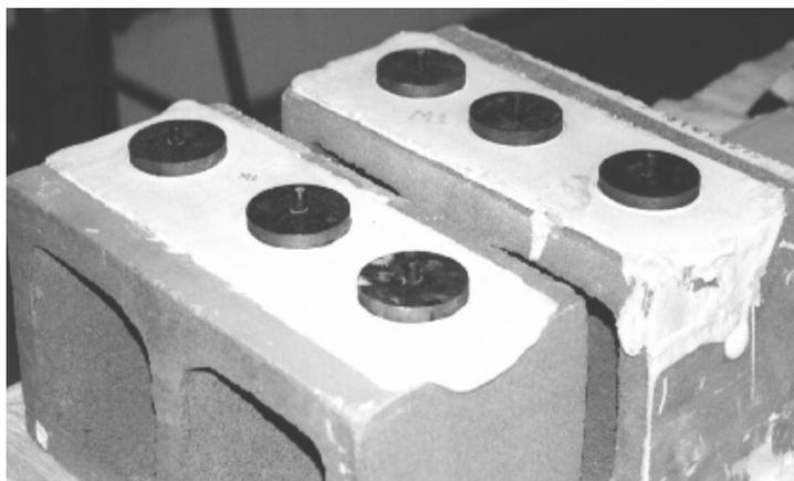
**Figura 6.12 – Fixação das placas de aço sobre os corpos-de-prova**
