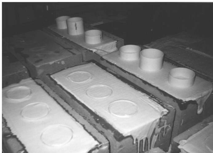
**Figura 6.11 – Moldagem dos corpos-de-prova**
