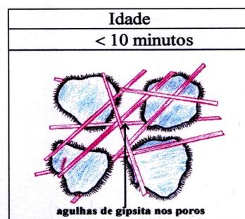
**Figura 4.16** Influência da reação aluminato/sulfato da fase aquosa –falsa pega (Mehta et al, 1994)
