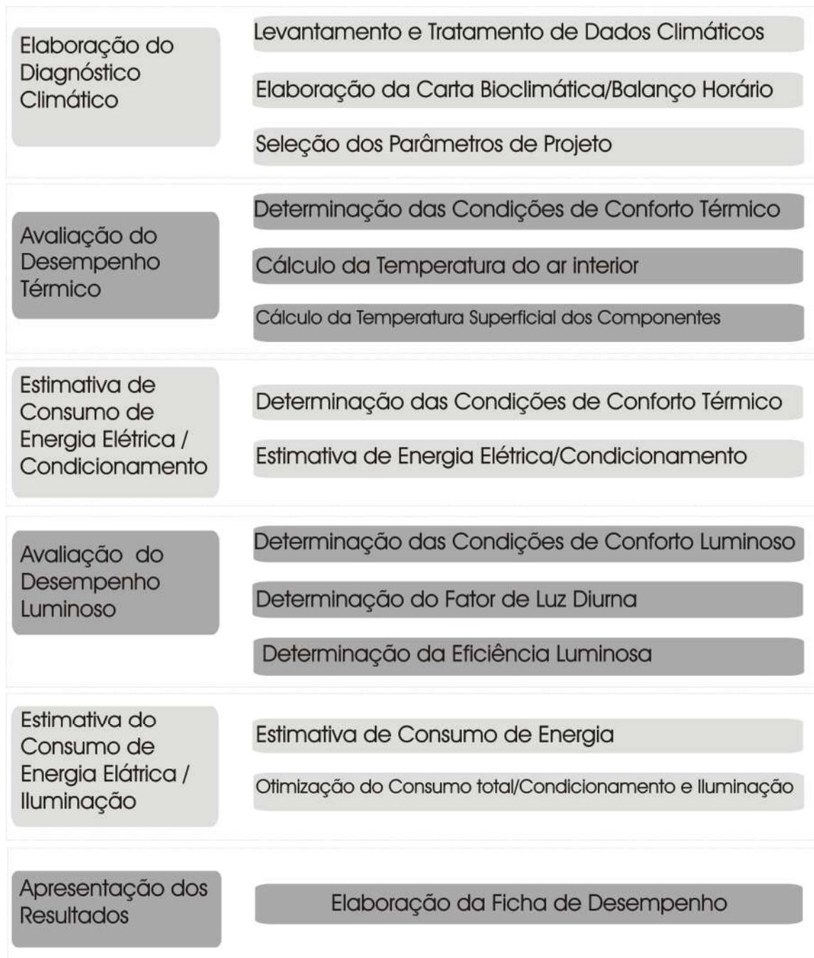
Ilustração 3 - Identificação dos Procedimentos propostos por Alucci para desenvolvimento e avaliação do projeto arquitetônico
