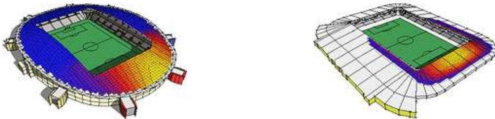
Ilustração 70 - Exemplo de utilização de análise de radiação solar solar incidente para projeto de cobertura envidraçada
