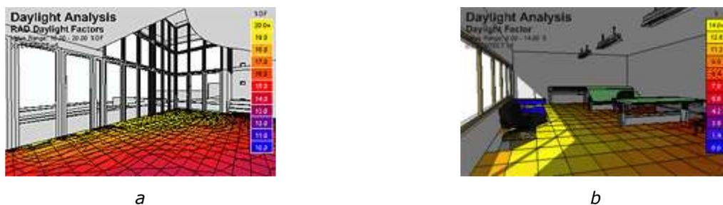
Ilustração 55 *a* e *b* - Exemplo de análise de fator de luz diurna níveis de iluminação em um grid
