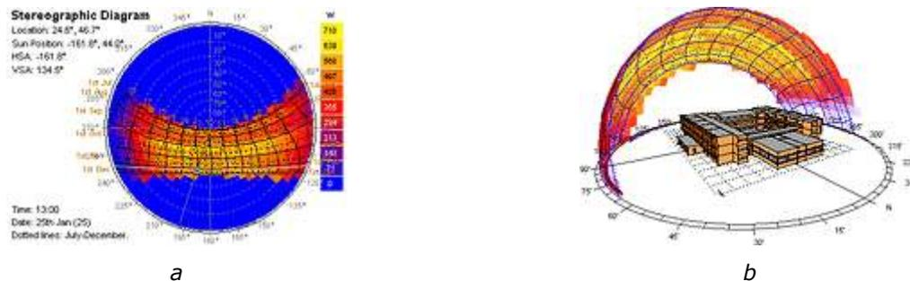
Ilustração 46 - Exemplo de ganhos solares em uma cobertura, demonstrado em uma carta solar (a) e em 3D com o modelo (b)
