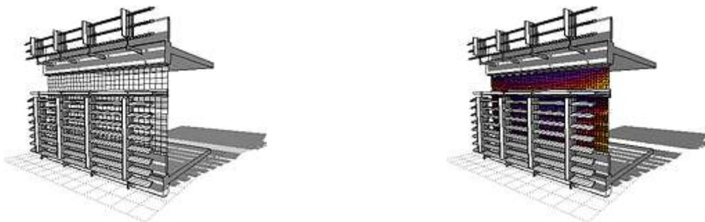
Ilustração 68 - Exemplo de inserção do grid de análise na posição vertical para estudo detalhado da radiação solar incidente
