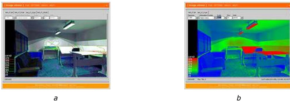
Ilustração 54 *a* e *b* - Exemplo de diagramas de lux contornados ou em cores falsas e imagens DF gerado pelo Radiance Image Viewer
