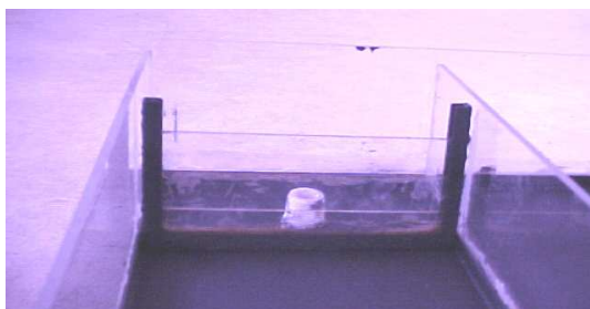
Figura 41 Vertedores de Entrada e Saída do Reator Solar
