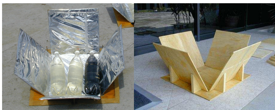
FIGURA 17 Modelo de Concentrador Solar proposto pelo IMTA - Instituto Mexicano de Tecnologia de Agua
