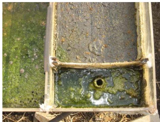
Figura 104 Foto do reator SODIS após 20 dias de operação
