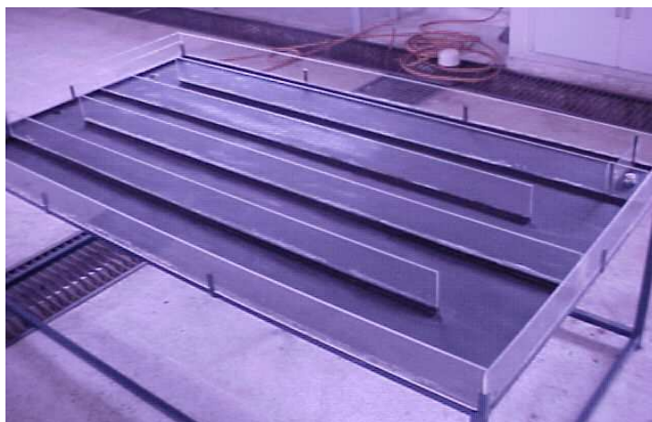
Figura 40 Foto do Reator Solar (sem a placa superior)
