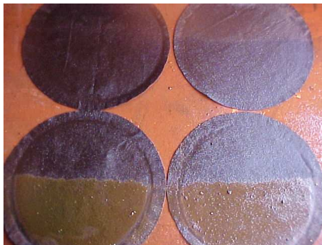
Figura 65 Mantas Sujas As duas de baixo são as superficiais e as duas de cima são as secundárias - A região central apresentada na foto já está limpa
