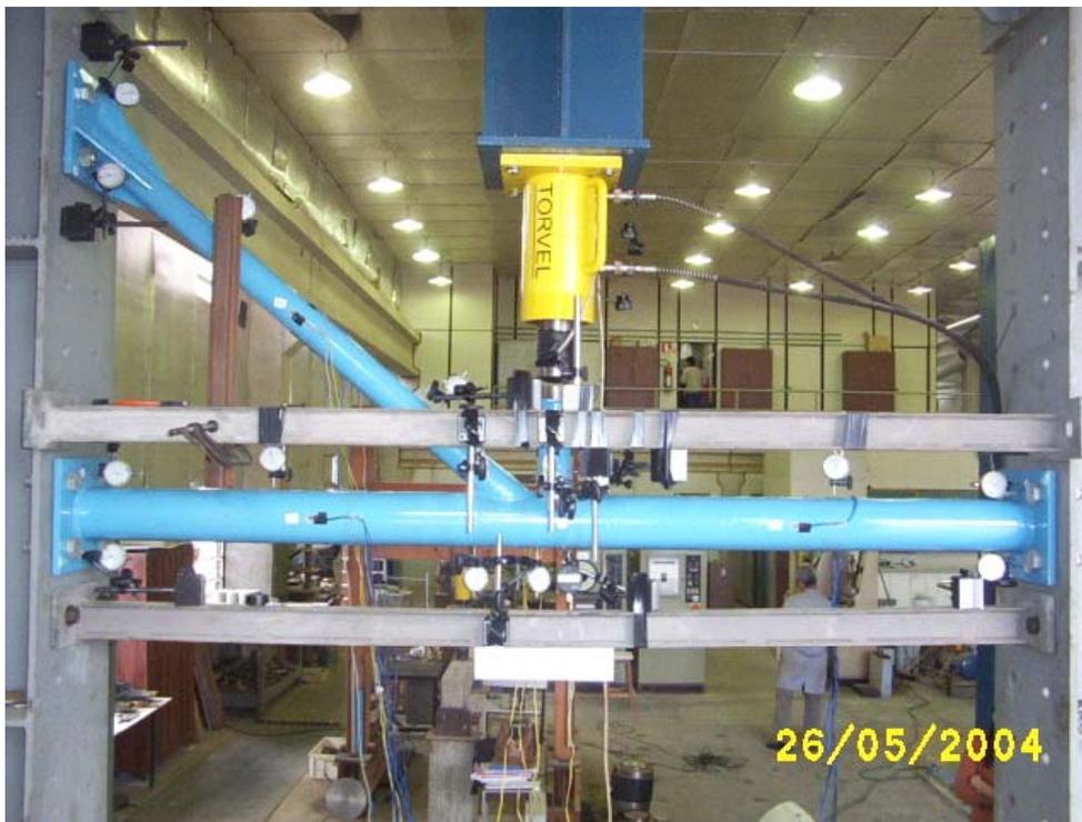
Figura 4.22 –Vista geral da instrumentação do protótipo da ligação YT.
