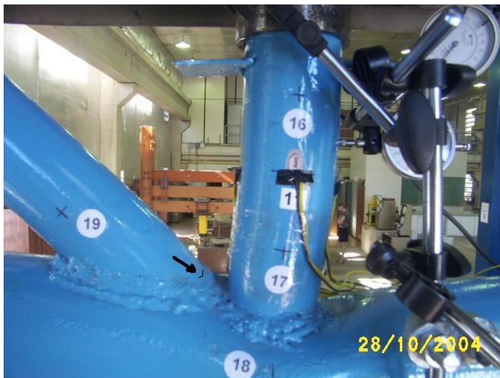
Figura 4.31 – Início da fissuração da solda.
