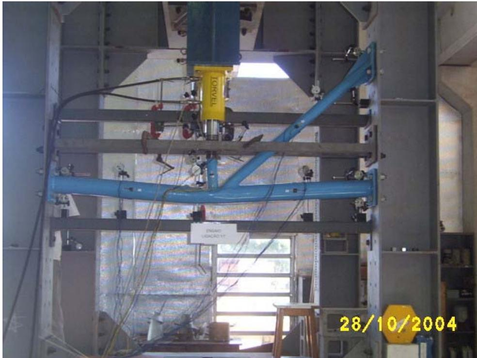
Figura 4.28 – Deformação global do protótipo da ligação YT.
