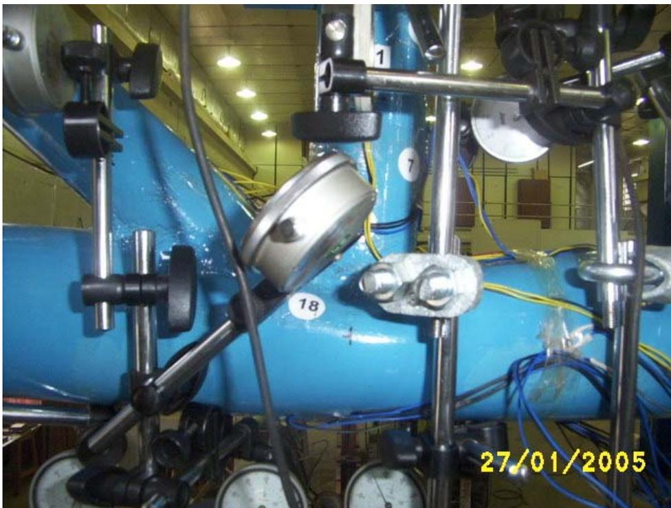
Figura 4.32 – Modo de colapso por plastificação da parede do banzo no ENSAIO III - Modo A.
