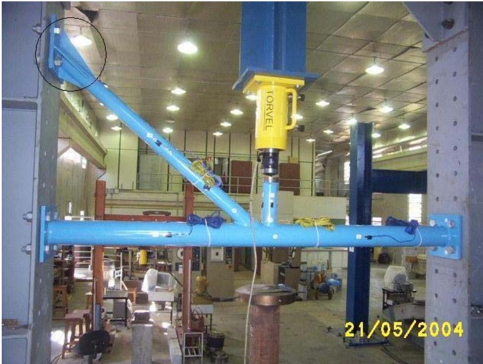
Figura 4.19 – Nervuras soldadas na chapa de extremidade da diagonal para o ENSAIO I, II e III.
