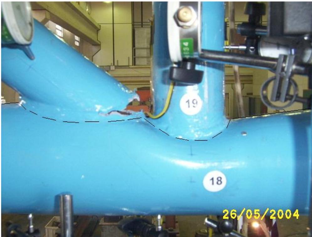
Figura 4.25 – Modo de colapso por plastificação da parede do banzo no ENSAIO I - Modo A.
