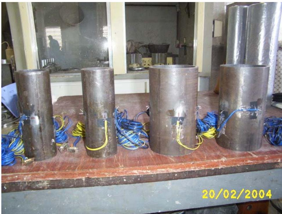
Figura 4.6 – Corpos-de-prova para ensaio de compressão.
