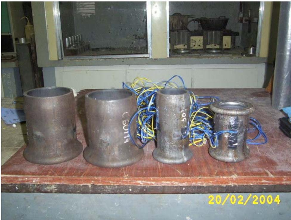
Figura 4.8 – Corpos-de-prova deformados após ensaio de compressão.
