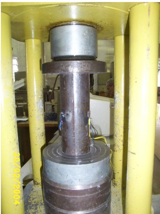
Figura 4.7 – Montagem do ensaio de compressão para o corpo-de-prova CP1.
