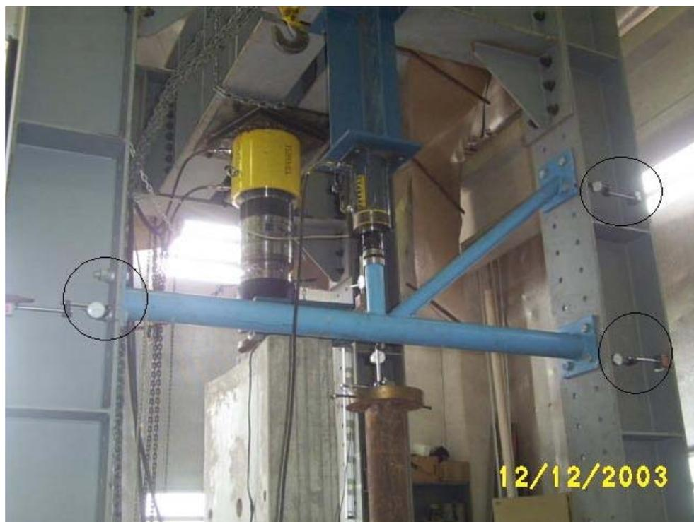
Figura 4.16 – Posicionamento dos TDs no pórtico de ensaio no pré-ensaio.
