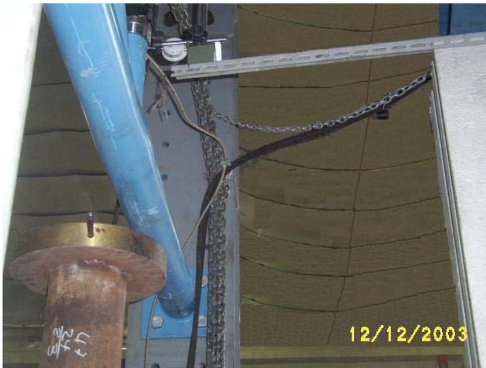
Figura 4.18 – Abaulamento do banzo no nó da ligação YT no pré-ensaio – Modo F.
