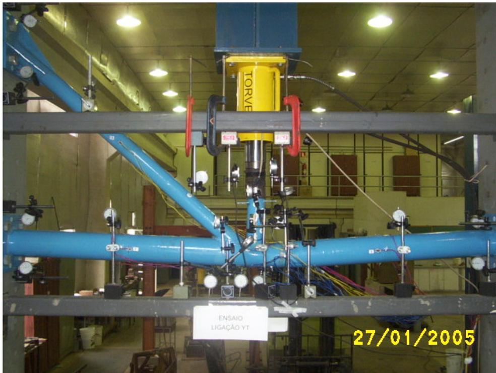
Figura 4.33 – Deformação global do protótipo.
