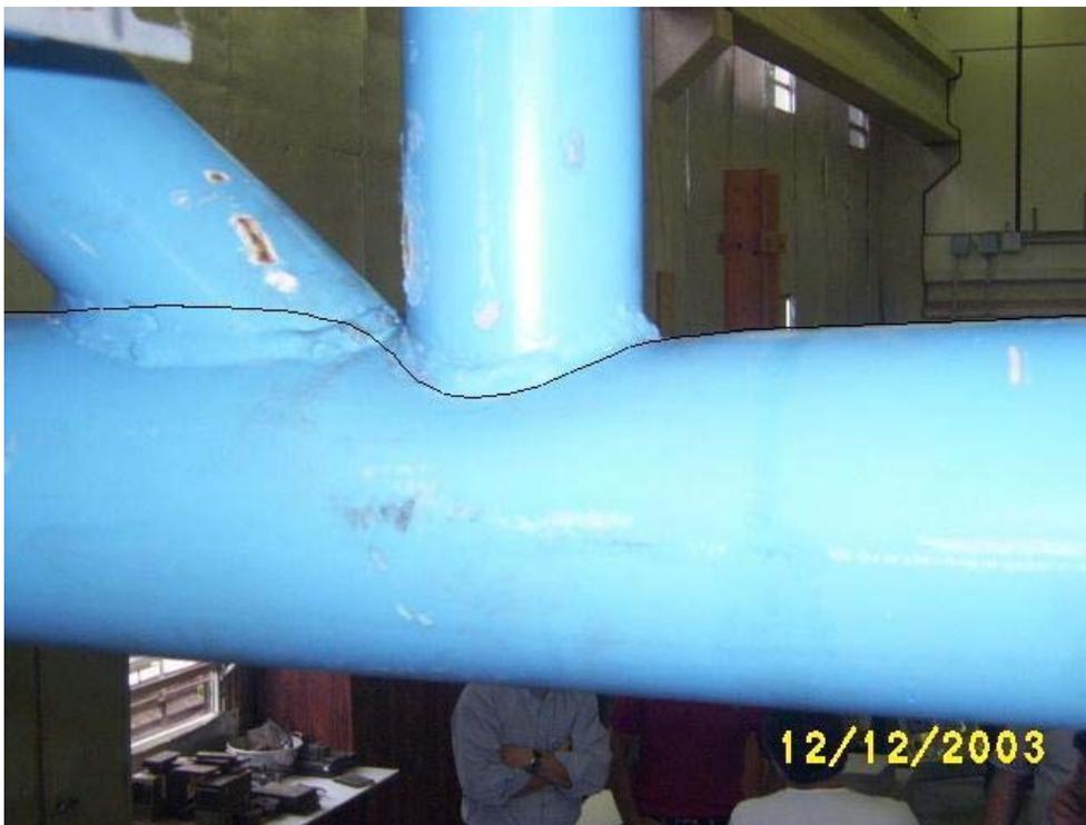
Figura 4.17 – Modo de colapso por plastificação da parede do banzo no pré-ensaio –
