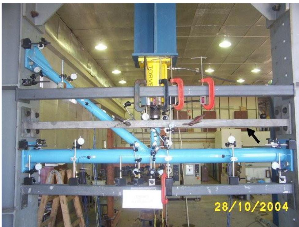
Figura 4.27 – Vigas de contenção lateral.
