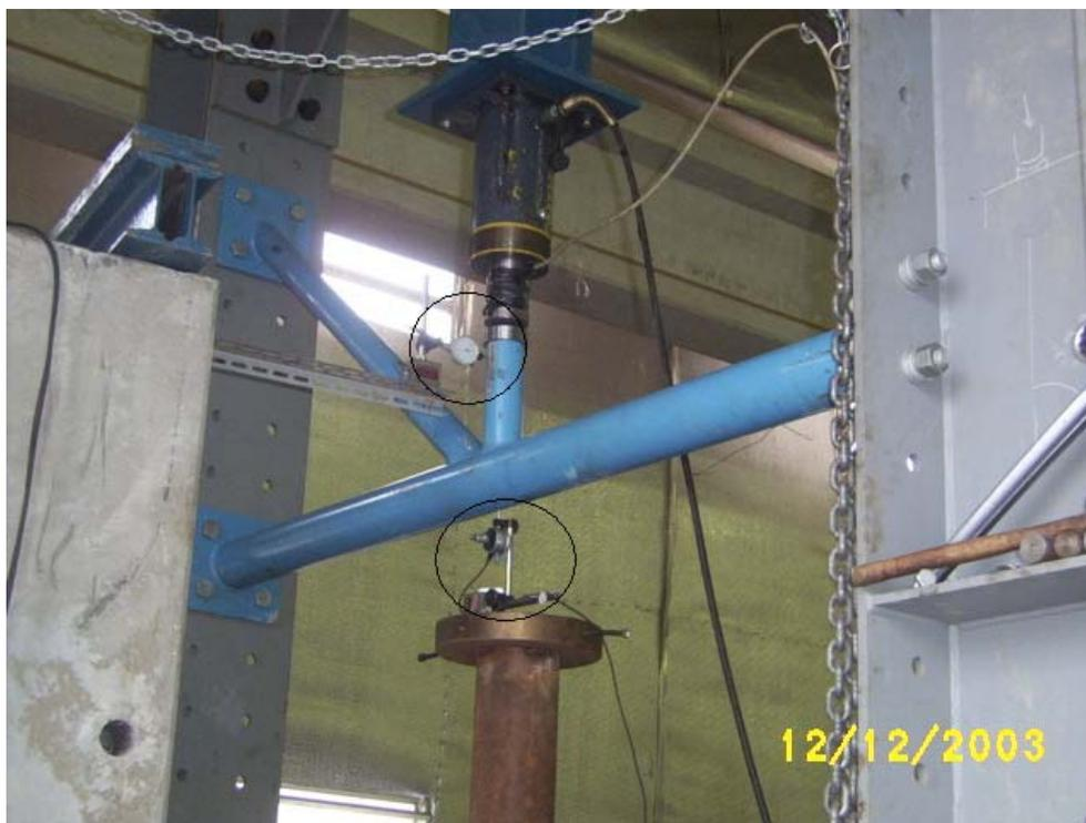
Figura 4.15 – Posicionamento dos TDs no protótipo de ligação YT no pré-ensaio.
