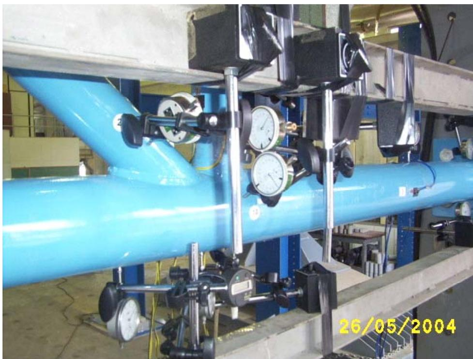
Figura 4.23 – Detalhe da instrumentação do protótipo da ligação YT.
