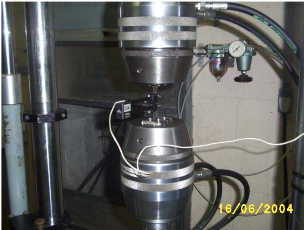
Figura 4.2 – Máquina de ensaio para ensaio de tração e do clip gage utilizado nos ensaios.
