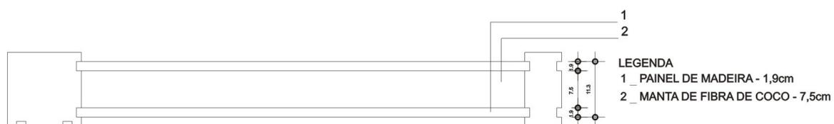
Figura 8.3: Painel de madeira dupla com isolante térmico – fibra de coco.
