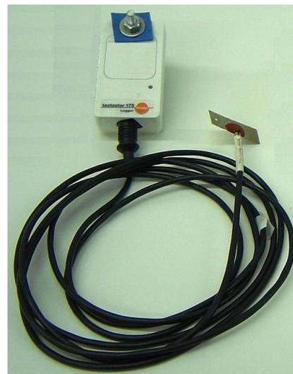
Figura 7.5: Datalogger Testo175-3 (temp. superficial)
