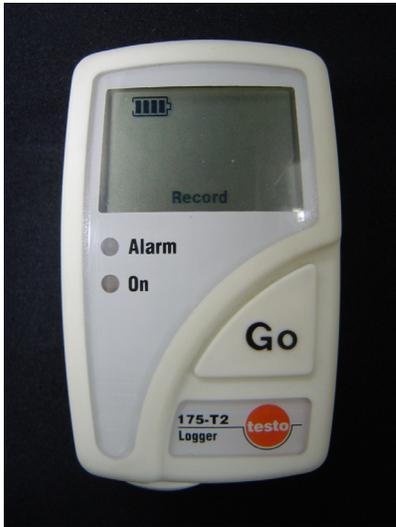
Figura 7.6: Datalogger Testo 175-T2.
