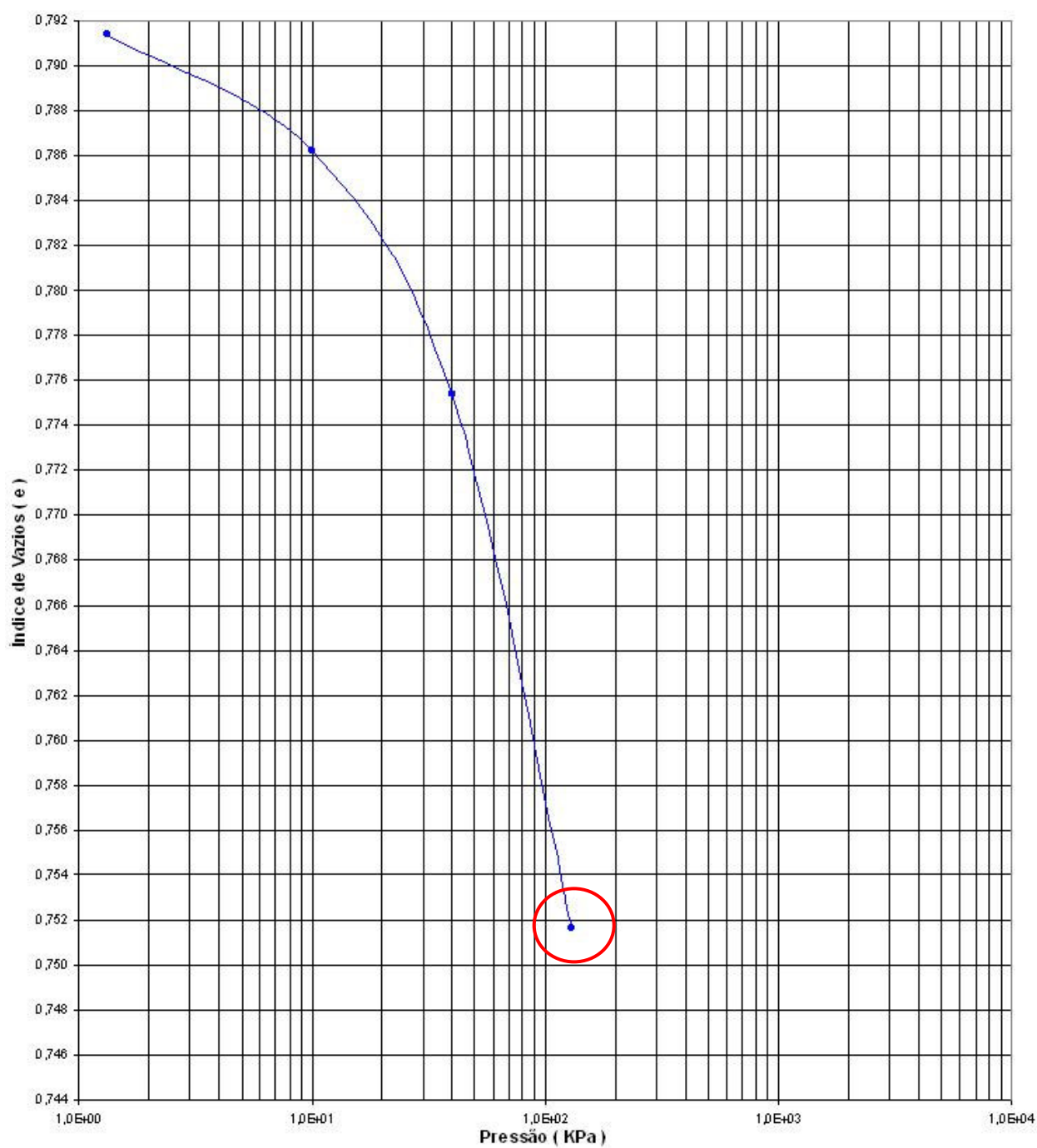
Figura 6.14 Ensaio edométrico simples da amostra a 1,00m de profundidade, com corpo de prova inundado na tensão de 130kPa
