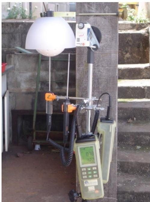
Figura 5.7 – Conjunto montado para verificar ventilação do sensor
