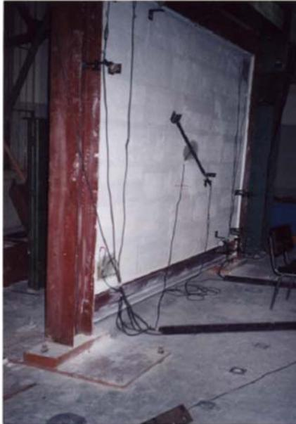
**Figura 2.3 – Ensaio de um dos pórticos em escala real (Alvarenga, 2002).**
