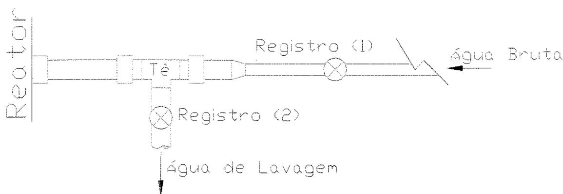
Figura 4.7: Detalhe esquematizado, com visão em planta da ligação da tubulação ao reator, com função de alimentação e descarga.
