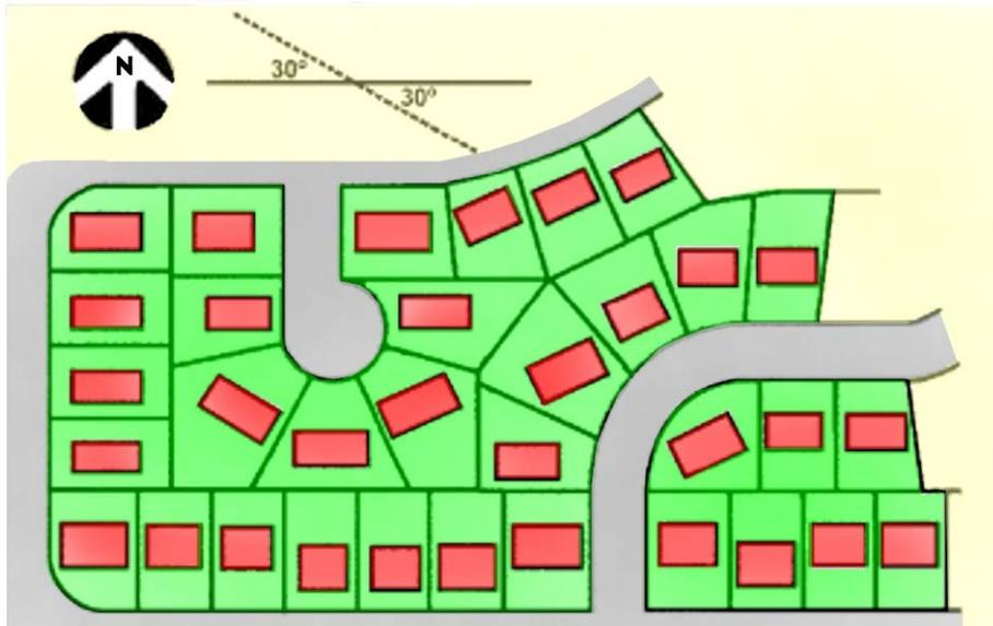
Fig. 27. Planta de um loteamento contemplando o regulamento. Fonte: Solar Access Guide or Solar Shadow Analysis, 2000. [www.ci.boulder.co.us/buildingservices](http://www.ci.boulder.co.us/buildingservices). Acesso em 07/abr/2007. Adaptado por Daniel B. Pérez, 2006
