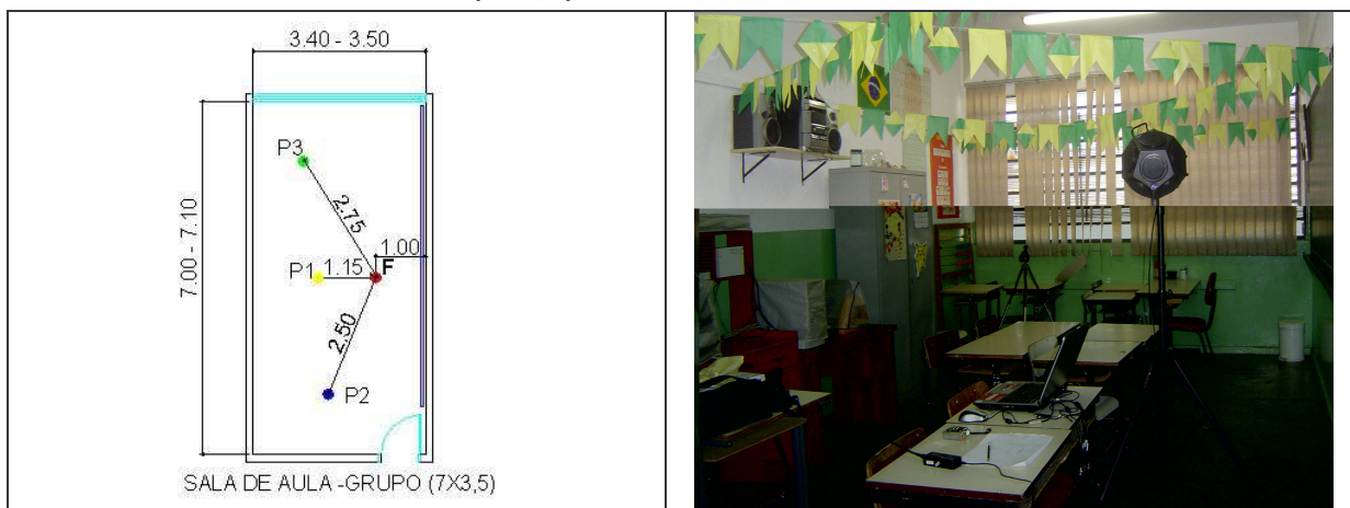
Figura O.1 : Localização dos pontos de recepção e respectivas distâncias da fonte (F) para salas do Grupo D (7x3,5m).
