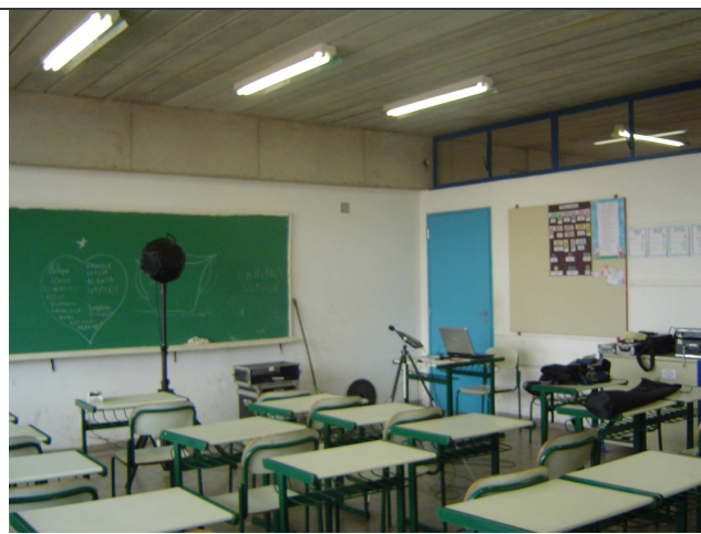
Foto B.1: Vista interna da sala de aula 2- CH EB1, com os equipamentos de medição acústica instalados. Data: 03/11/2006.
