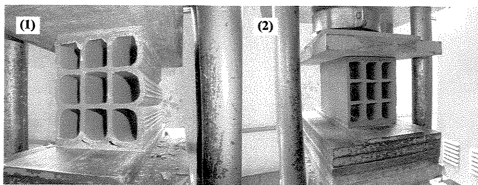
Figura19 – (1) Bloco moldado com paredes curvas; (2) Bloco moldado com paredes retas.
