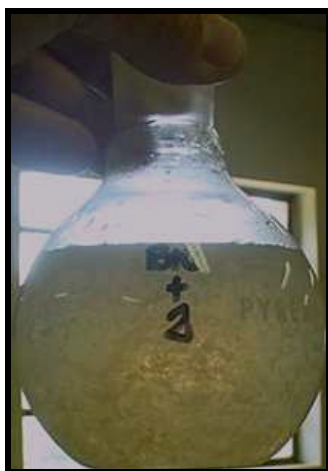
Figuras 4.26: VISTA DA CLARIFICAÇÃO DA AMOSTRA BRUTA COM ADIÇÃO DE 2 mL DE PAC Fonte: MENDES (2005)
