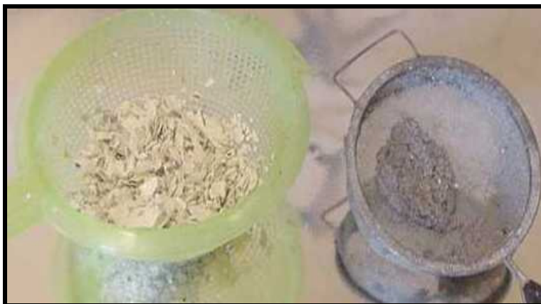
Figura 4.18: VISTA DO ASPECTO DOS PLÁSTICOS LAVADOS E DOS RESÍDUOS GROSSEIROS RETIDOS NA OPERAÇÃO DE GRADEAMENTO Fonte: MENDES (2005)
