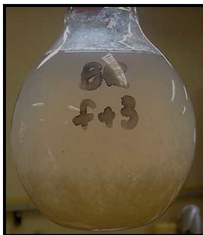
Figuras 4.27: VISTA DA CLARIFICAÇÃO DA AMOSTRA BRUTA COM ADIÇÃO DE 3 mL DE PAC Fonte: MENDES (2005)
