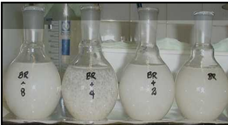
Figura 4.24: VISTA DA COMPARAÇÃO ENTRE AMOSTRAS BRUTAS COM VARIAÇÃO NA DOSAGEM DE PAC Fonte: MENDES (2005)
