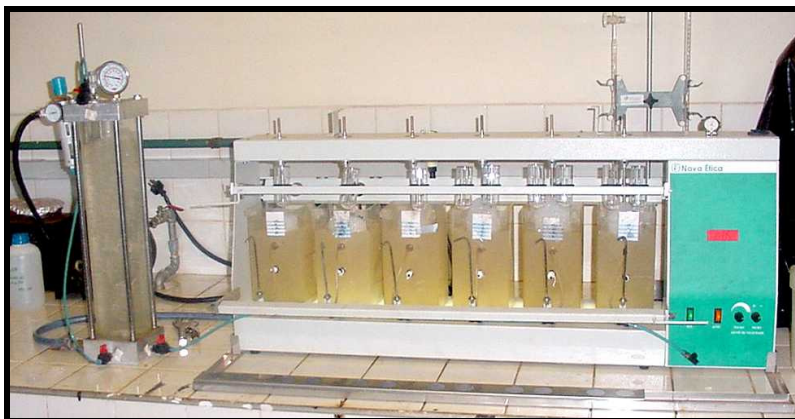
Figura 4.15 – VISTA DO APARELHO DE JARTESTE OU FLOTESTE, ONDE FORAM REALIZADOS OS ESTUDOS DE TRATAMENTO POR PROCESSO FÍSICO-QUÍMICO DOS EFLUENTES GERADOS NAS LAVAGENS DOS PLÁSTICOS Fonte: MENDES (2005)
