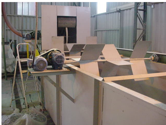
Figura 4.6: VISTA GERAL DO CANAL DE LAVAGEM E COLETA DE PLÁSTICOS FLUTUANTES Fonte: MENDES (2006)
