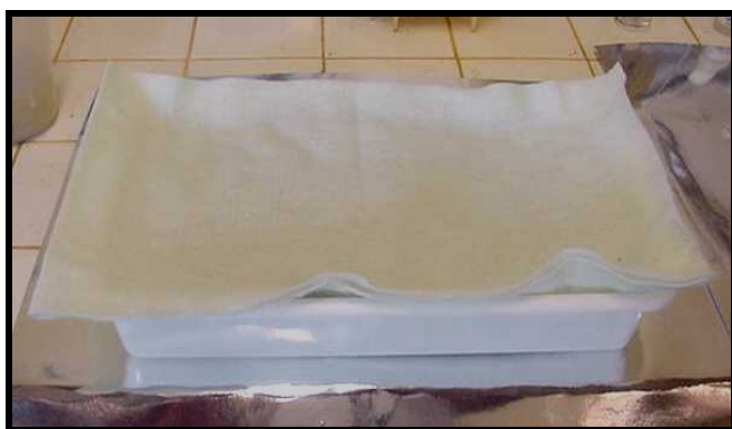
Figura 4.19: VISTA DO DETALHE DA MANTA NÃO TECIDA UTILIZADA NA OPERAÇÃO DE RETENÇÃO DOS SÓLIDOS GROSSEIROS APÓS GRADEAMENTO Fonte: MENDES (2005)
