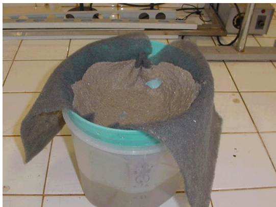
Figura 4.29: VISTA DO ASPECTO DO LODO FILTRADO EM MANTA TIPO BIDIM, SIMULANDO O PRÉ-TRATAMENTO Fonte: MENDES (2006)
