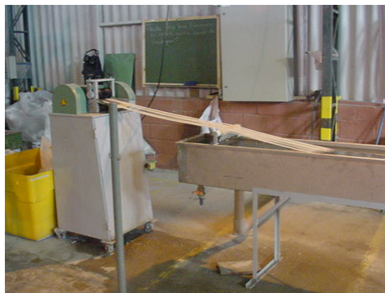
Figura 4.11: VISTA DOS FIOS DE PLÁSTICOS (ESPAGUÊTES) FORMADOS NA EXTRUSÃO, SUBMETIDOS AO RESFRIAMENTO EM CANAL COM ÁGUA Fonte: MENDES (2006)
