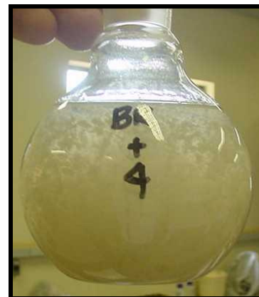
Figura 4.25: VISTA DA AMOSTRA BRUTA COM ADIÇÃO DE 4mL DE PAC Fonte: MENDES (2005)
