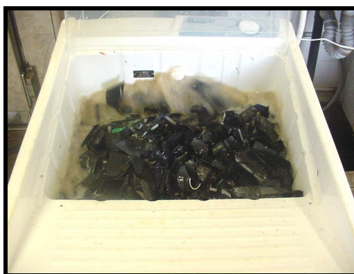
Figura 4.13: VISTA DOS PLÁSTICOS SENDO LAVADOS NO TANQUINHO Fonte: MENDES (2005)
