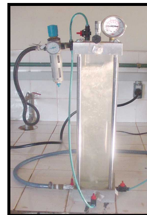
Figura 4.16 – VISTA DA CÂMARA DE SATURAÇÃO DE ÁGUA PARA FORNECIMENTO DE AR NOS ENSAIOS DE FLOTAÇÃO Fonte: MENDES (2005)
