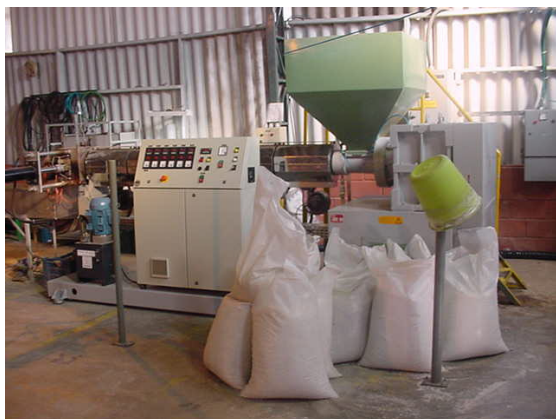
Figura 4.10.: VISTA DO SILO DE CARGA E EXTRUSORA EXISTENTE NA LABORMAX Fonte: MENDES (2006)
