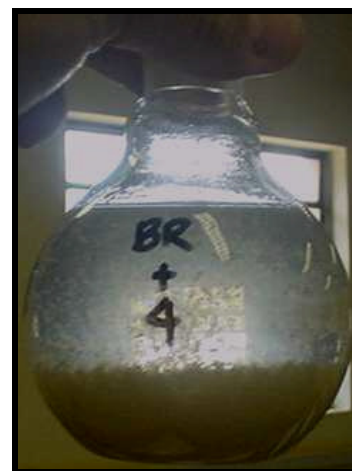
Figuras 4.28: VISTA DA CLARIFICAÇÃO DA AMOSTRA BRUTA COM ADIÇÃO DE 4mL DE PAC Fonte: MENDES (2005)
