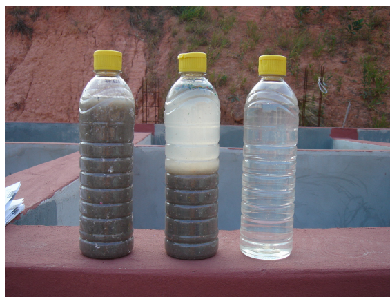
Figura 4.51: ASPECTO DAS AMOSTRAS BRUTA, DECANTADA E CLARIFICADA FINAL, OBTIDAS NOS TESTES INAUGURAIS Fonte: MENDES (2006)
