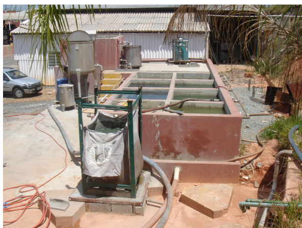
Figura 4.48: TESTE DE ARMAZENAMENTO DE LODO EM “BIG BAGS” Fonte: MENDES (2006)
