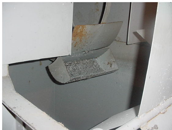
Figura 4.7: VISTA DO EQUIPAMENTO ROTATIVO DE COLETA DE PLÁSTICOS FLUTUANTES Fonte: MENDES (2006)
