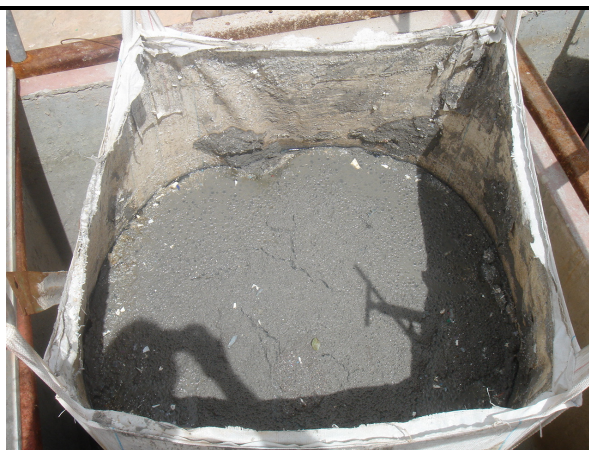
Figura 4.49: ASPECTO DO LODO APÓS 24 HORAS DE DRENAGEM DE LÍQUIDOS Fonte: MENDES (2006)
