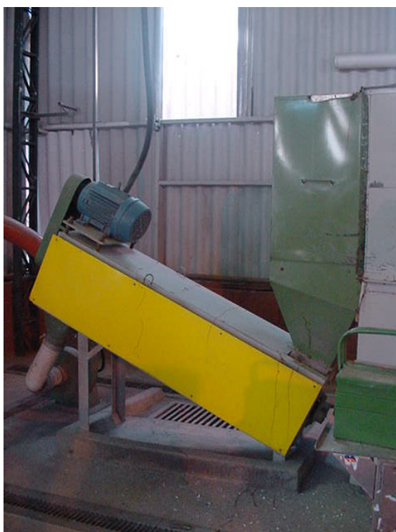
Figura 4.8: VISTA DO EQUIPAMENTO TIPO PARAFUSO DE ARQUIMEDES, PARA TRANSPORTE DOS PLÁSTICOS PICADOS E LAVADOS ATÉ O SECADOR Fonte: MENDES (2006)
