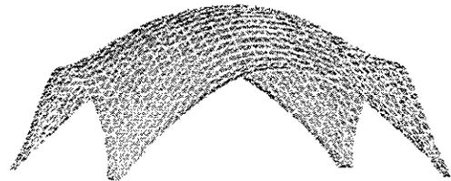
Figura 19 - Casca de forma livre obtida pelo carregamento da membrana flexível com peso próprio.
