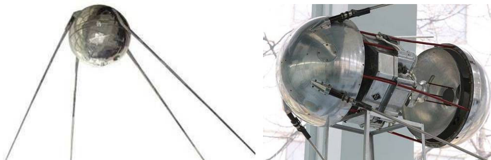
Figura 30. Mecanismo articulável para expansão/contração do Satélite Sputnik (THEDECIBELTOLLS, 2010; NPOINTERCOS, 2010).
