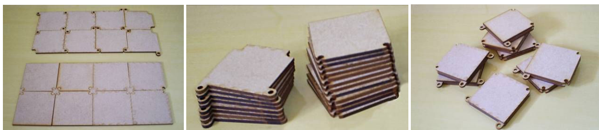
Figura 76. Chapas com as peças já cortadas; peças separadas; e conjunto com três peças coladas (autor, 2010).
