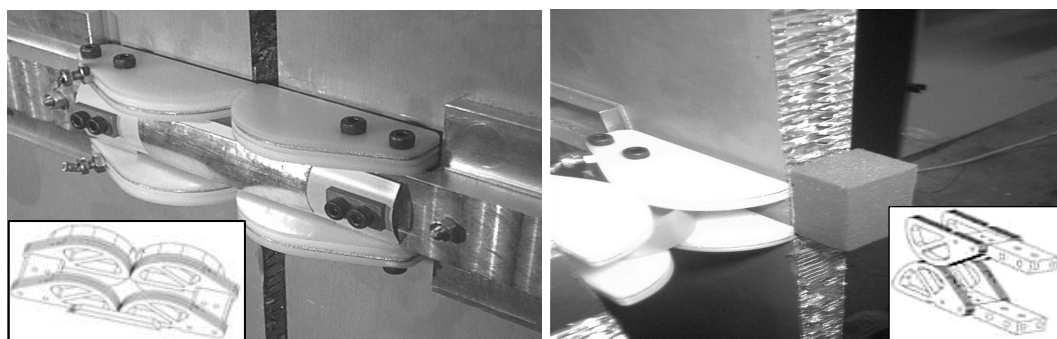
Figura 33. Dobradiça para estruturas articuláveis desenvolvida por Pellegrino et al. (2002) na Universidade de Cambridge.
