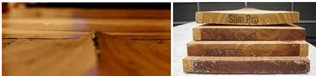
Figura 61. Inchamento e retração provocados pela variação da umidade na madeira (autor, 2010).
