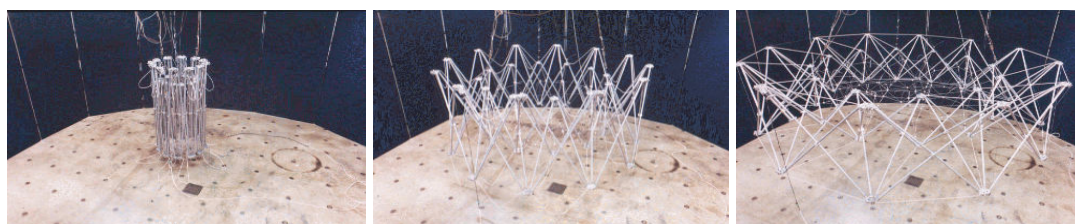
Figura 24. Análise em laboratório da sequência de articulação de um protótipo de antena (TIBERT, 2002).
