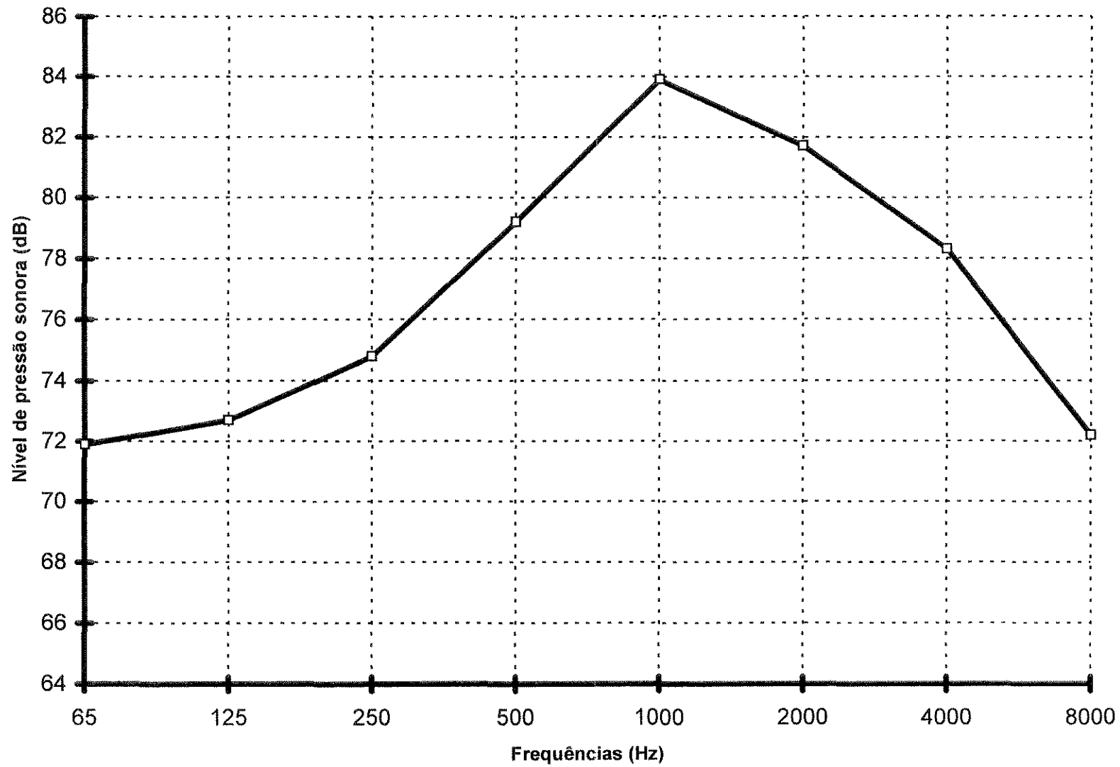
Espectro de frequência de 1/1 oitava para máquina manual motorizada
