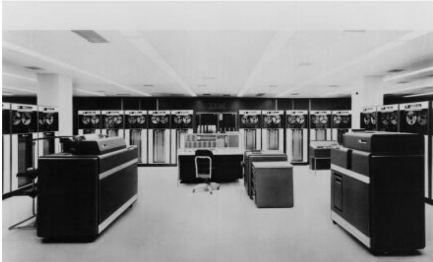
**Figura 17** - Computador IBM-7090, da segunda geração de servidores transistorizados, fabricado entre 1958 e 1969.
