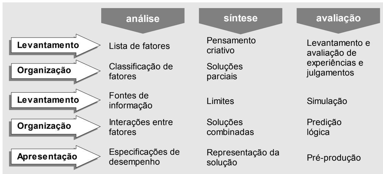
Figura 2 - Etapas do método sistemático de projeto.
