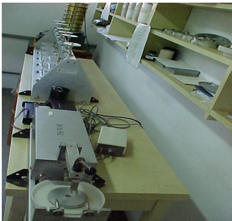
Fig. 45 – Vista superior do equipamento Jenike Shear Tester
