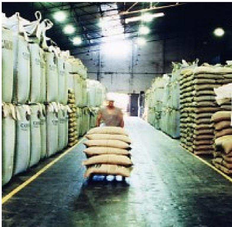
Fig. 07 – Emblocamento de cafés em sacos: armazenagem em big-bags (à esquerda); armazenagem em sacos (à direita)
