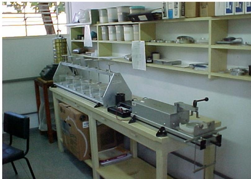
Fig. 44 – Foto do equipamento Jenike Shear Tester
