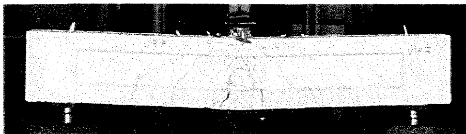
FIGURA 6.24 Panorama da fissuração na viga suporte
