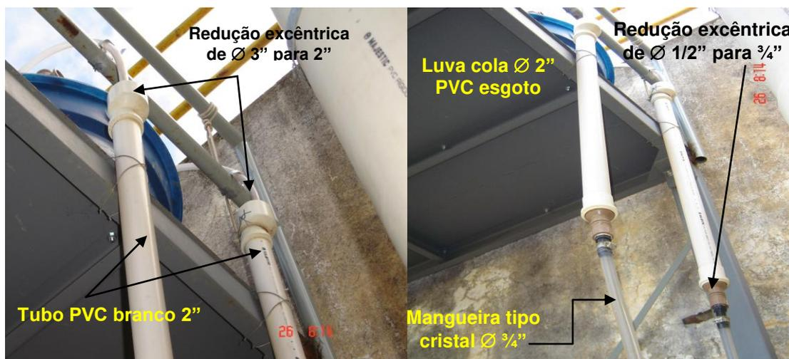
**Figura 4.13 - Fotografias das conexões de entrada dos reatores piloto de floculação ascendente dos reatores R1 e R2**
