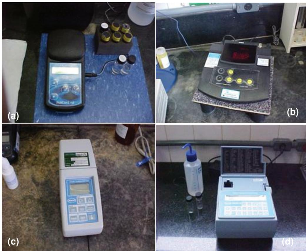
**Figura 4.15 - Fotografias dos instrumentos de medição utilizados nas análises físico-químicas: (a) colorímetro cor; (b) potenciômetro para pH; (c) turbidímetro e (d) espectrofotômetro**
