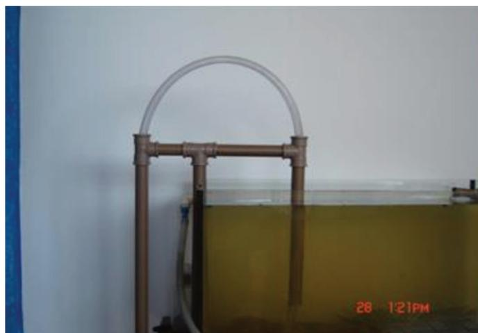
**Figura 5.12 - Fotografia de concepção inicial do sistema de sifonamento hidráulico durante a pesquisa**
