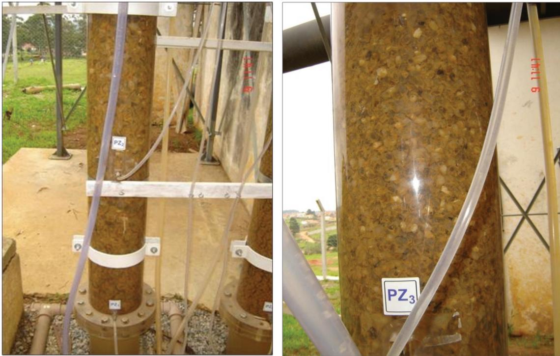
**Figura 5.33 - Fotografias do reator R1 com formação de flocos (carreira de operação 13 em 09/12/2007)**
