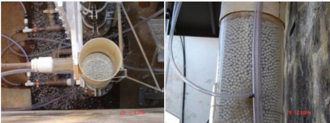
**Figura 5.10 - Fotografias do reator R2 com enchimento de esferas**
