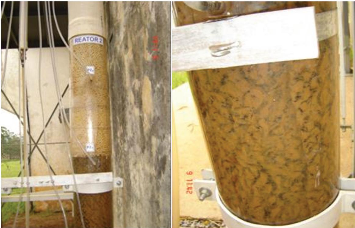
**Figura 5.34 - Fotografias do reator R2 com formação de flocos (carreira de operação 13 em 09/12/2007)**
