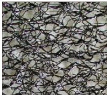
**Figura 3.9 - Fotografia da geomanta utilizada nos reator R2 - Fonte: MACCAFERRI, 2009**
