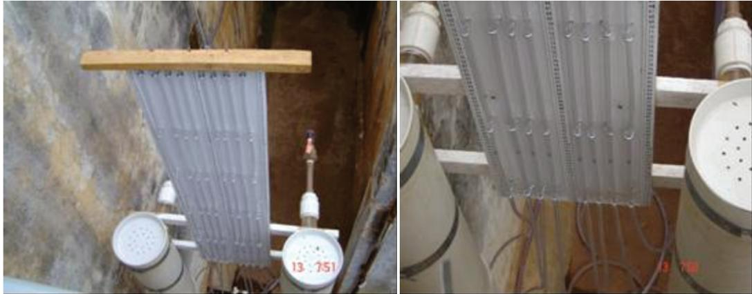
**Figura 4.11 - Fotografias mostrando o quadro piezométrico**
