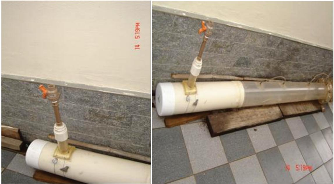
**Figura 5.3 - Fotografias dos reatores de tubos de acrílico após o processo de recuperação**
