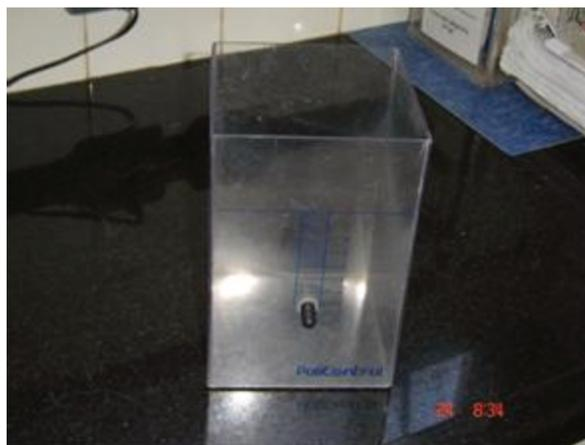
**Figura 4.14 - Fotografia do jarro de seção quadrada (2L) utilizado para coleta de amostras para análises físico químicas e sedimentação dos efluentes dos reatores R1 e R2**
