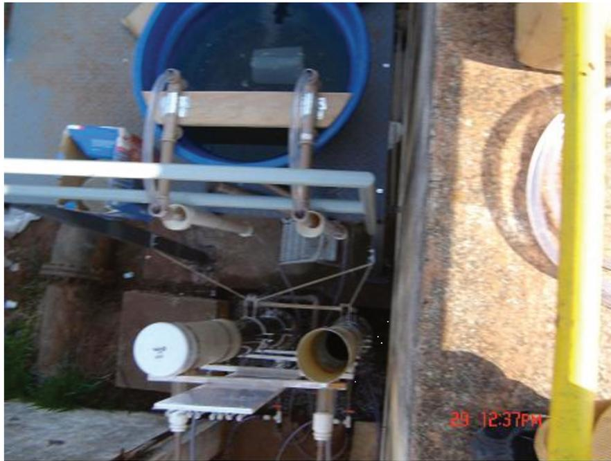
**Figura 5.13 - Fotografia mostrando o sistema de sifonamento instalado na plataforma do trabalho de pesquisa**
