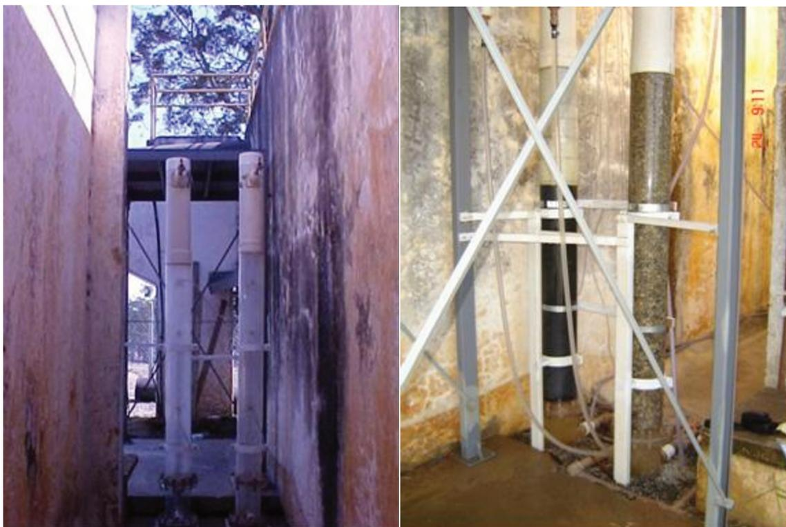
**Figura 5.6 - Fotografias mostrando os reatores instalados e seus sistemas de fixação à plataforma**
