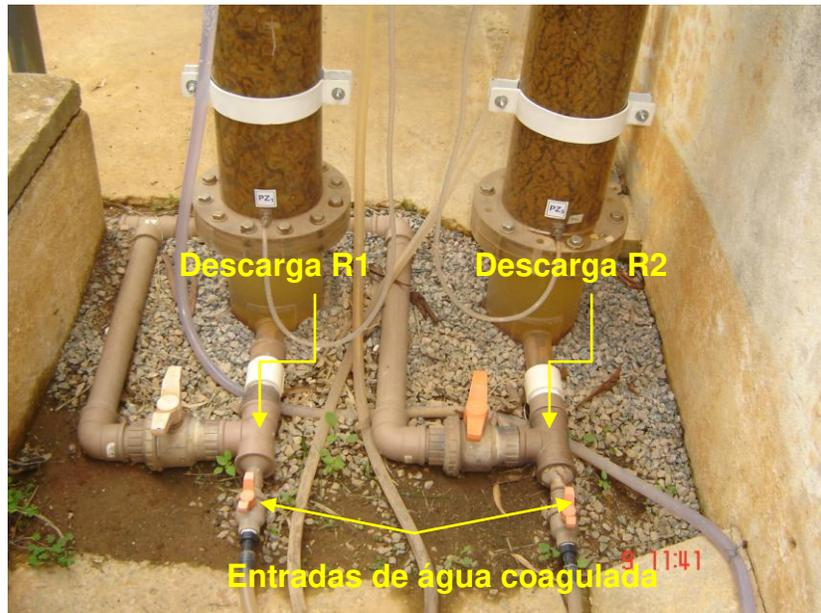
**Figura 4.6 - Fotografia das conexões de descarga, limpeza e entradas de água coagulada dos reatores piloto de fluxo ascendente dos reatores R1 e R2**
