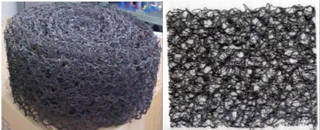
**Figura 4.9 - Fotografia mostrando seção de malha utilizada como meio poroso do reator R2**
