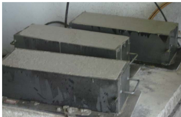
Figura A.12 – Vigas prismáticas moldadas, adensadas na mesa vibratória e com acabamento superficial pronto.
