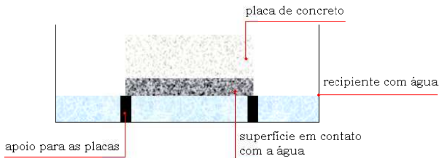
Figura A.5 – Procedimento para saturar uma face da placa de concreto, antes do aquecimento.
