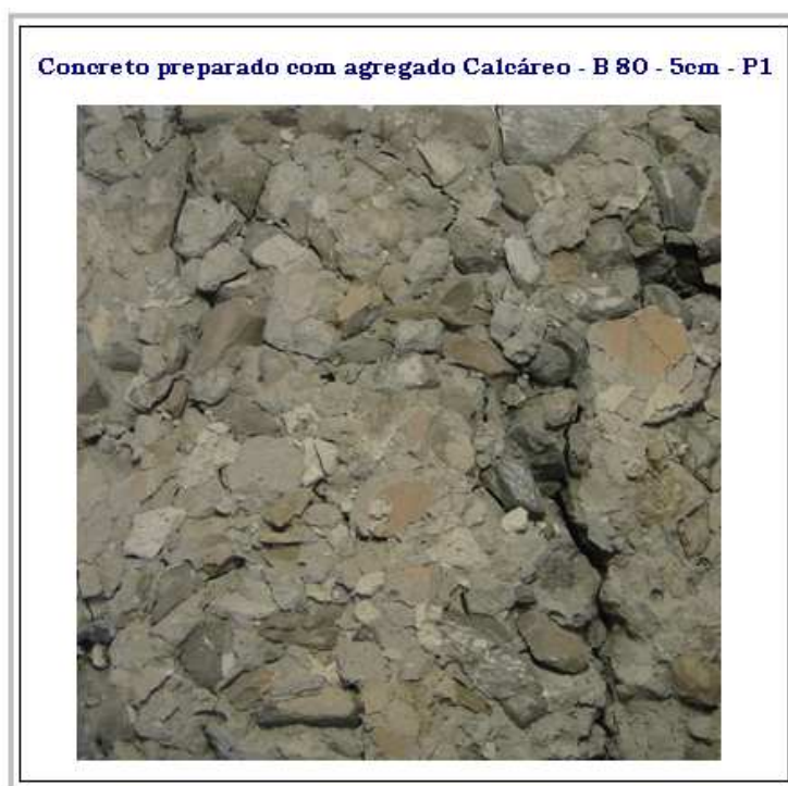
Figura 7.8 - Placa de concreto preparada com agregado calcáreo, de resistência igual a 80 MPa, após aquecimento na Curva Padrão ISO 834:1975, durante 60 minutos.
