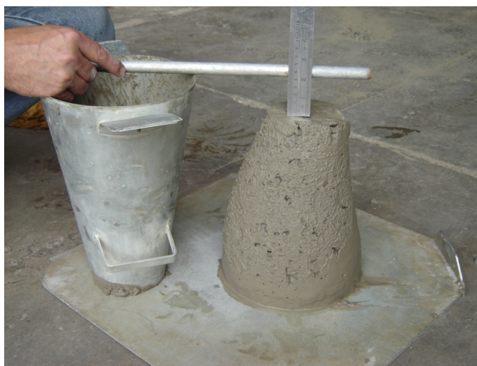
Figura A.13 – Ensaio de abatimento do tronco de cone para uma mistura de concreto.
