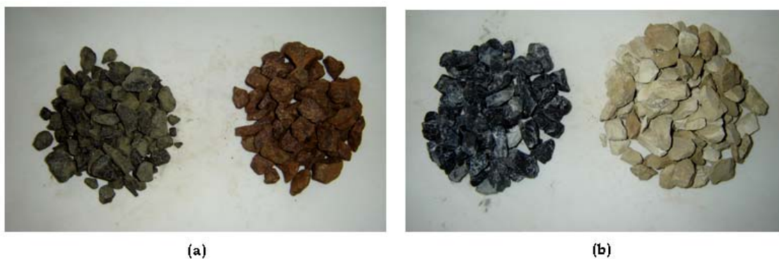
Figura 7.9 - Alteração de massa e cor dos agregados utilizados, após serem aquecidos na Curva Padrão, durante 60 minutos: (a) basalto e (b) calcáreo.
