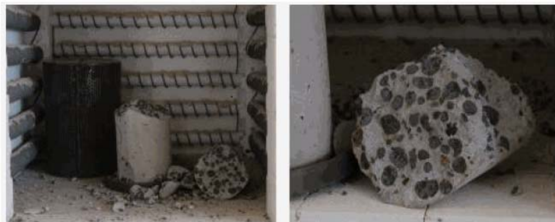
Figura 5.6 - Explosão ocorrida no concreto preparado com agregado leve (argila expandida) após aquecimento à 600°C, com teor de umidade igual ao do ambiente e baixa taxa de aquecimento (SOUZA, 2005).
