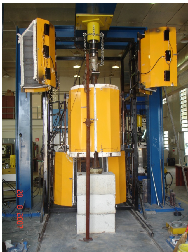
Figura 1.6 – Forno elétrico específico para avaliação de pilares de tamanho real em situação de incêndio.
