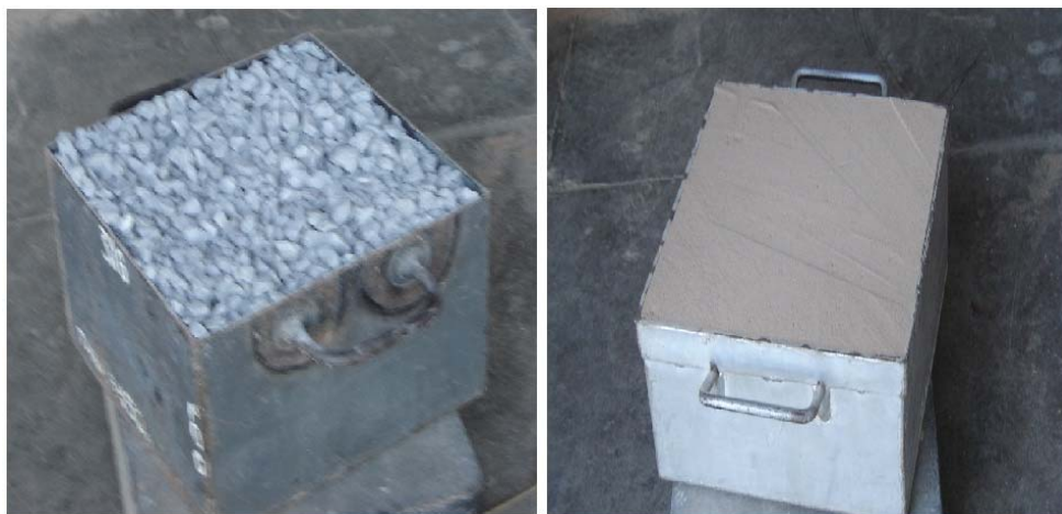
Figura A.11 - Ensaio de massa específica no estado solto; (a) agregado graúdo calcáreo e (b) agregado miúdo areia eólica.
