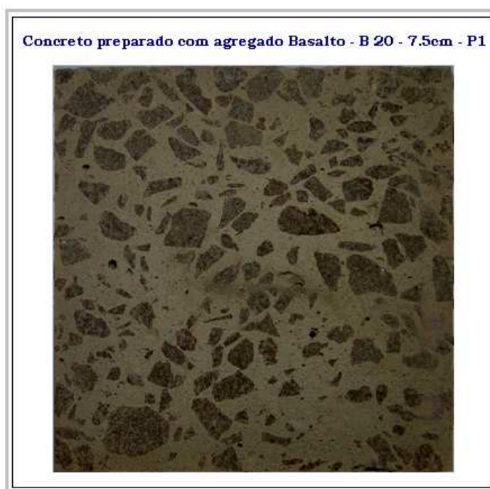
Figura 7.3 – Detalhe da superfície da face aquecida da placa de concreto de 20MPa e 7.5cm de espessura preparada com agregado basalto.
