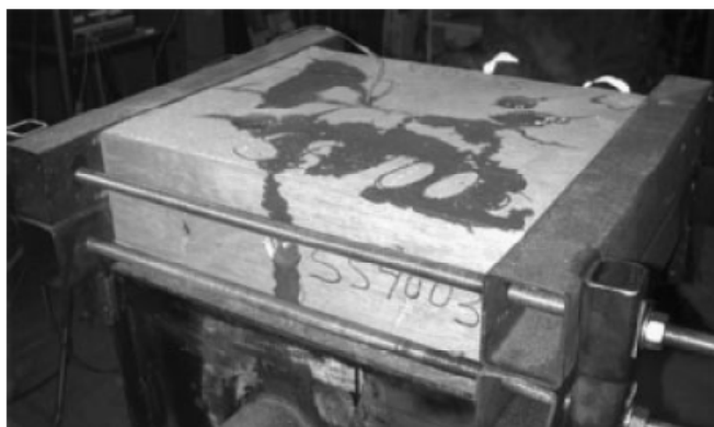
Figura 5.13 – Aumento de fissuras ajuda a saída de água e vapor do interior da amostra (BOSTRO, WICKSTRÖM & ADL-ZARRABI, 2006).
