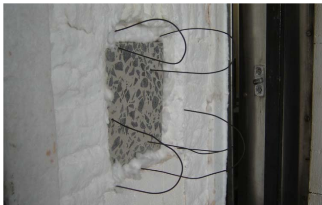
Figura 7.2 – Placa posicionada no vão da porta do forno, com o isolamento e a disposição dos termopares em detalhe.
