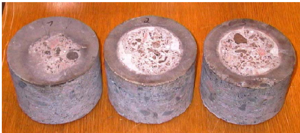
Figura 5.19 - Corpos-de-prova de concreto aquecidos pelo método proposto (HERTZ & SORENSEN, 2005).
