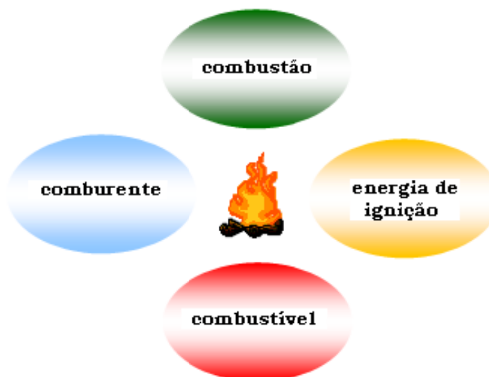
Figura 2.1 – Agentes necessários à combustão: comburente, combustível e energia de ignição.
