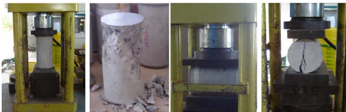
Figura A.14 - Ensaio de compressão axial e diametral nos corpos-de-prova cilíndricos, aos 28 dias de idade.
