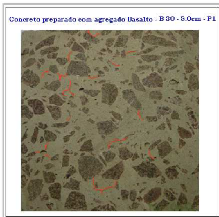
Figura 7.7 - Fissuras marcadas na superfície aquecida do concreto preparado com agregado basalto, de resistência igual a 30 MPa e espessura igual a 5.0cm.
