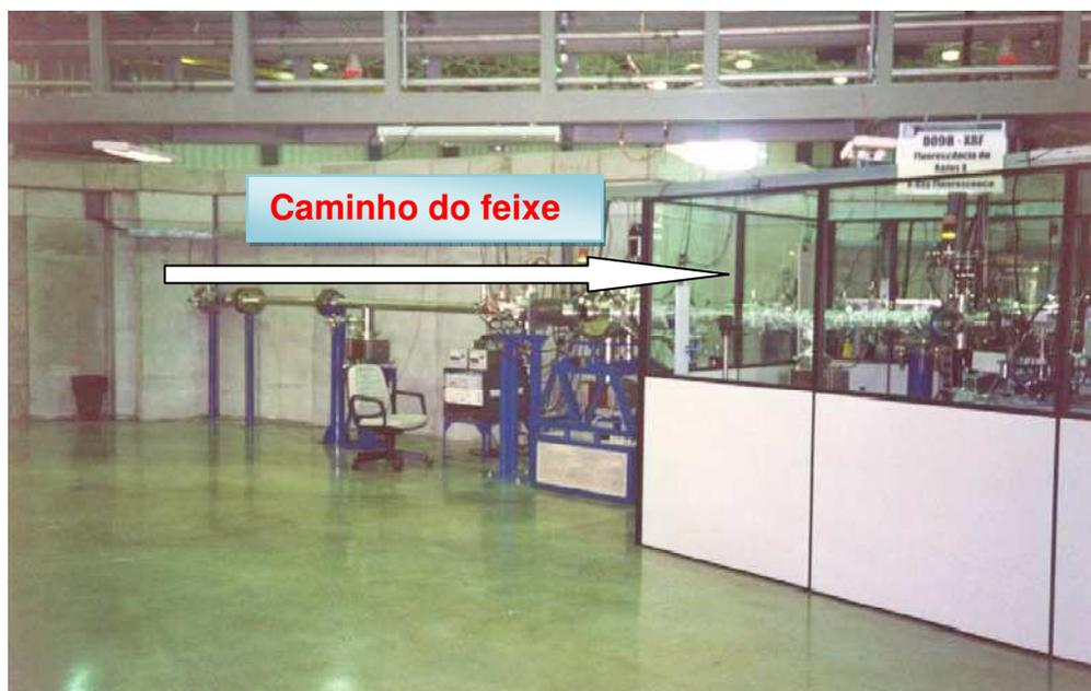
**Figura 5.9** – Foto da tubulação do anel para a linha DO9B – XRF do Laboratório Nacional de Luz Síncrotron, por onde passa o feixe de luz síncrotron.
