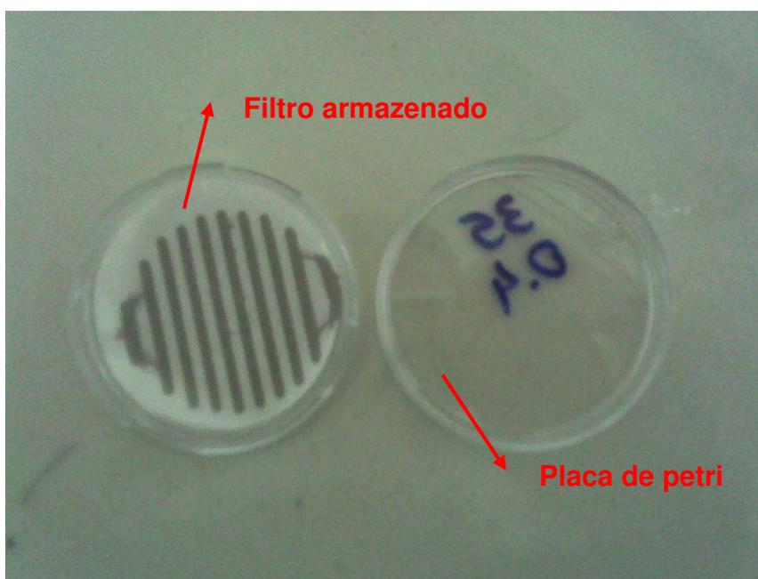
**Figura 5.6** - Filtro usado e armazenado na placa de Petri.
