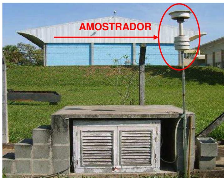
**Figura 5.1**– Vista externa do sistema com destaque para torre do amostrador (equipamento projetado na FEC).
