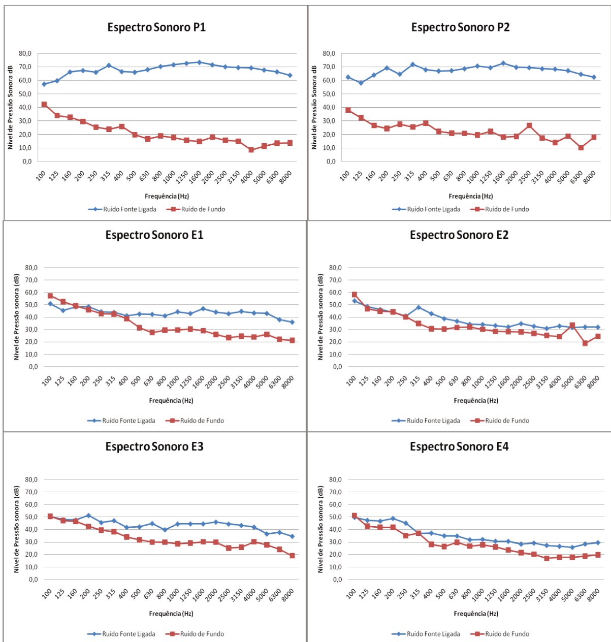
Figura 7.45: Níveis de Pressão sonora (dB) em função da frequência (Hz) – Reserva da Serra
