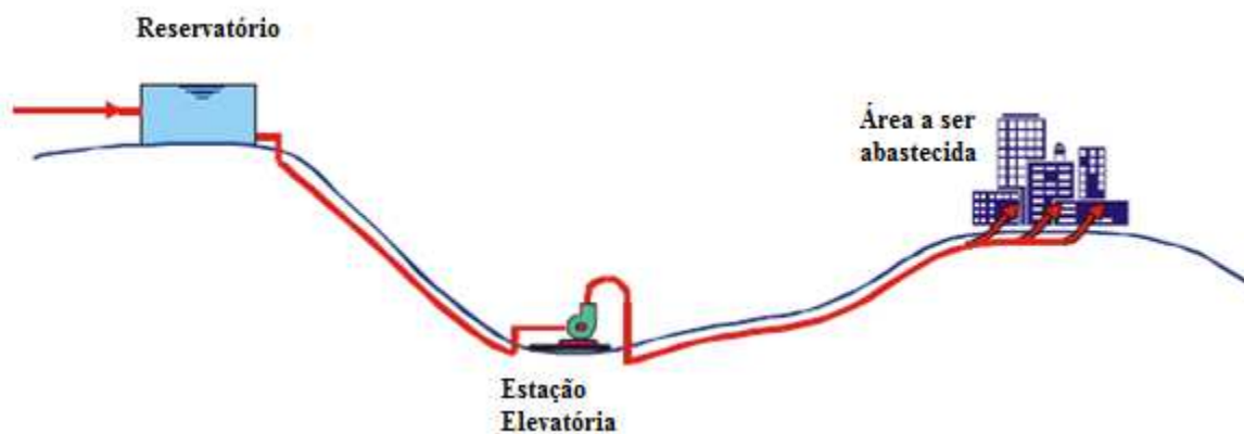
Figura 5.4 – Bombeamento de água tipo Booster (TSUTIYA, 2006)
