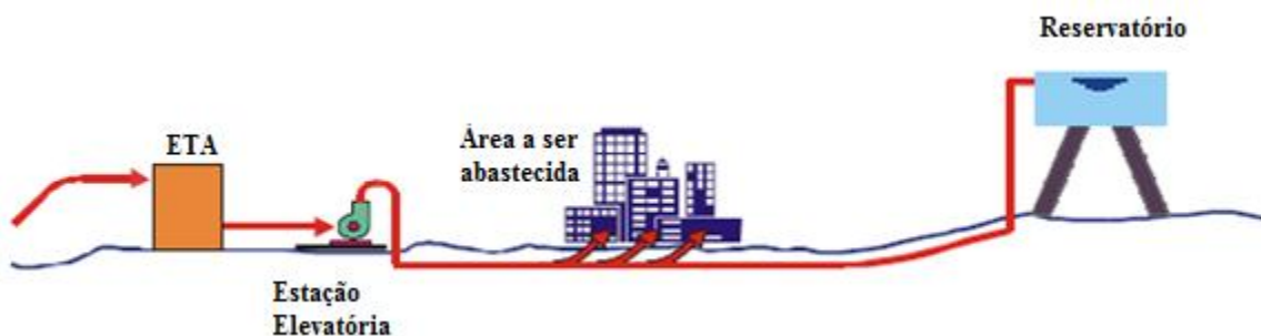
Figura 5.5 – Bombeamento de água diretamente para a rede de distribuição com reservatório elevado a jusante (TSUTIYA, 2006)
