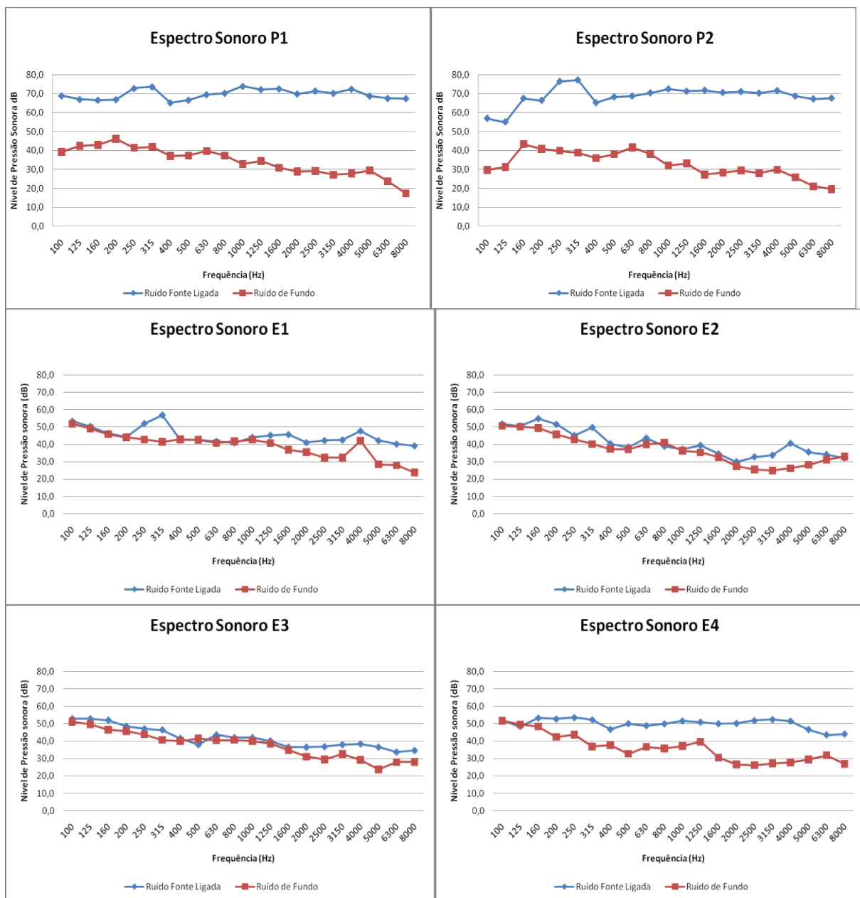
Figura 7.29: Níveis de Pressão sonora (dB) em função da frequência (Hz) - Malota
