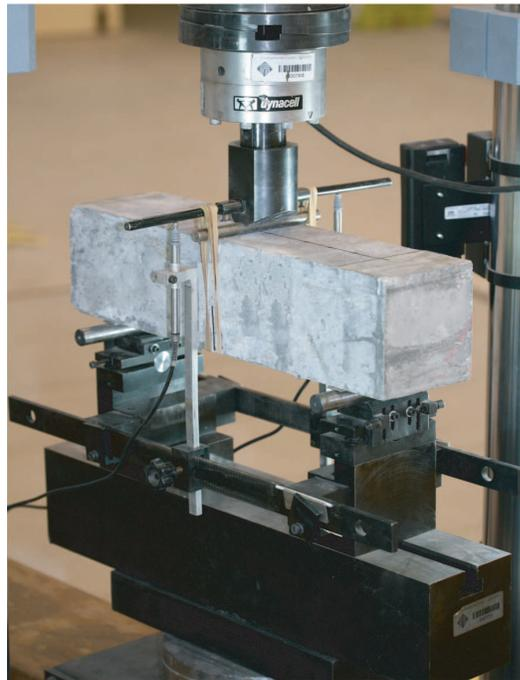
Figura 3.10: Configuração experimental do ensaio TPBT(a); e detalhes da instrumentação (b).
