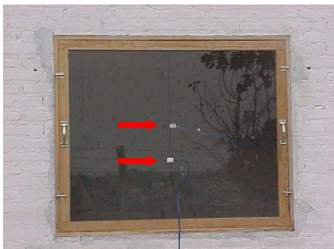
FIGURA 25 – Termopares colados no vidro
