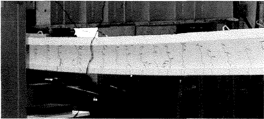
FIGURA 5.30- Configuração de fissuras para V202
