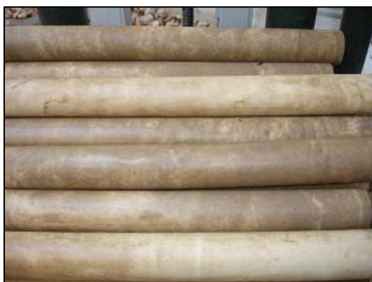
Fig. 5.11 Filtros de Polipropileno saturado Fig. 5.12 Filtros de Polipropileno Extrudado
