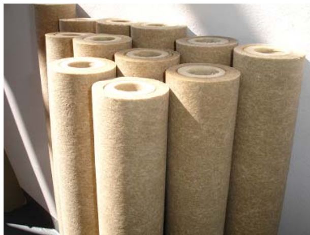
Fig. 4.15 - Unidade contendo 12 filtros de cartuchos
