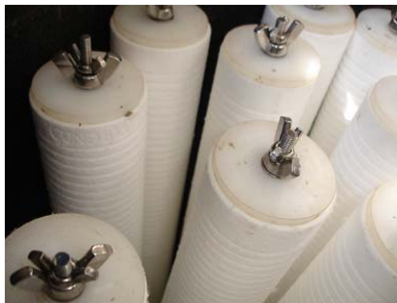
Fig. 4.12 - Detalhe dos filtros de polipropileno
