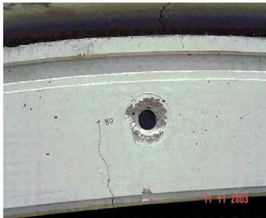
**Figura 58 Primeira fissura em virtude do esmagamento do concreto nos apoios e anotação da magnitude da carga (80 Tf).**
