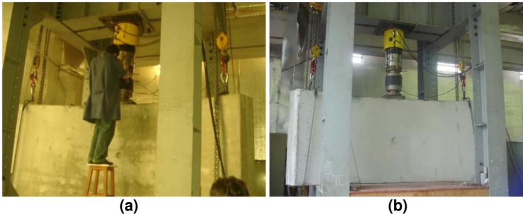
**Figura 49 (a) Preparação e calibração dos equipamentos, e (b) realização do ensaio de fendilhamento na aduela.**
