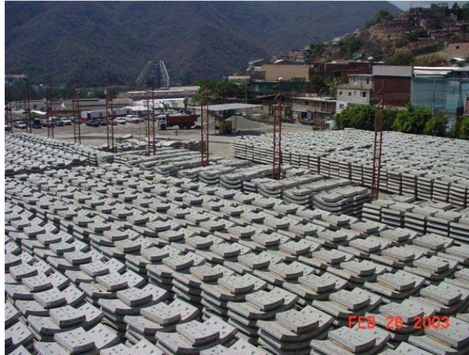
**Figura 4 “Pulmão” de aduelas em uma fábrica de anéis<sup>71</sup>.**
