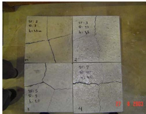
Figura 23 Padrão de fissuração das placas após a execução dos ensaios, variando-se o teor de fibras conforme os traços utilizados.
