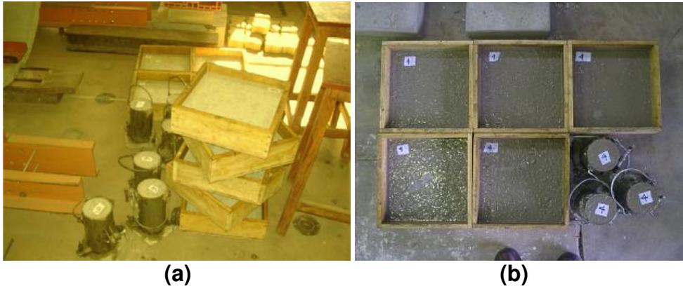
Figura 22 (a) e (b) Corpos-de-prova para cada traço estudado na resistência ao impacto.
