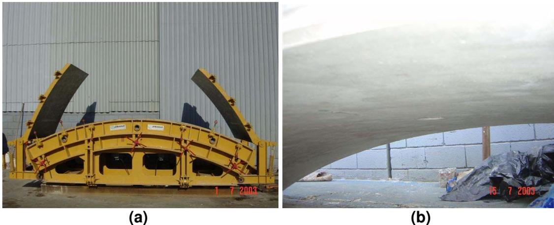
**Figura 33 (a) Fôrma de aço de alta precisão utilizada e (b) acabamento na superfície do inferior da aduela após a moldagem.**
