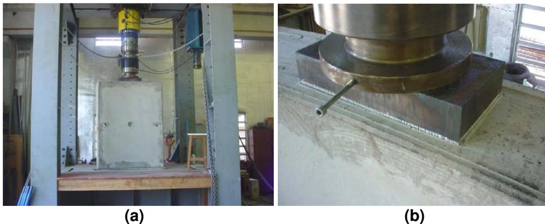
**Figura 50 (a) Ensaio de fendilhamento executado na chave<sup>161</sup>, e (b) chapa de distribuição de carga da estrutura de reação (capacidade 500 Tf).**
