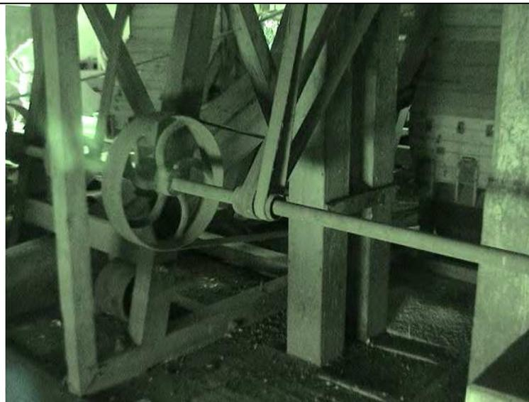
**Descrição:** Serraria: Sistema de transmissão de energia para a Serra, todo metálico. Provável segundo período.
