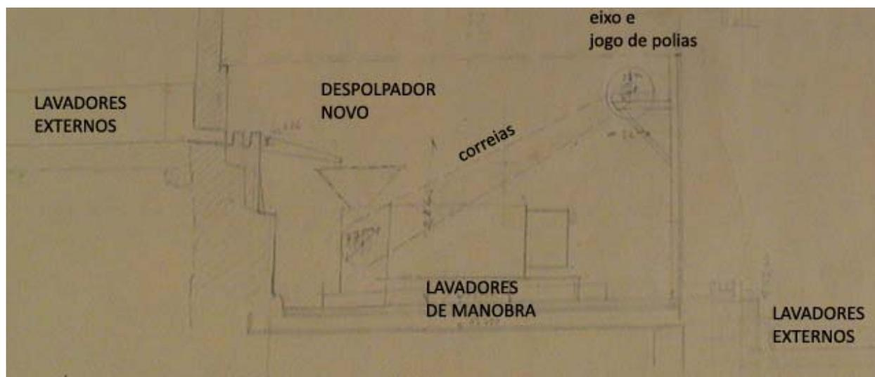
Figura 3 – STC – Usina de Despulpamento, Secagem e Benefício de Café de Botucatu – Seção de Despulpamento.
