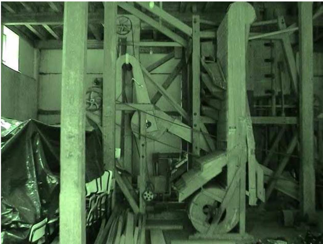
**Figura 138 - Aerador/classificador implantado na telha, em 1935.**
