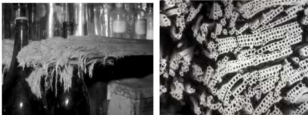
**Figura 61: Degradação devido ação de produtos químicos.**
