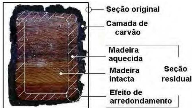
Figura 33: Seção de uma viga de madeira laminada colada, exposta ao fogo durante 30 minutos.
