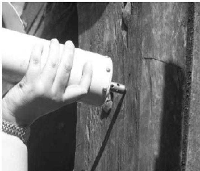
**Figura 75: Uso do Resistógrafo.**
