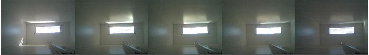
Figura 5.45 – Seqüência das imagens internas para 9:00h, 10:30h, 12:00h, 13:30h e 15:00h (da esquerda para direita)
