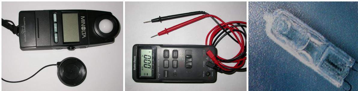
**Figura 4.12 - Instrumentos para calibração do sistema- A) Luxímetro Minolta B) Multímetro Radio Shack. C) Halopin® 60W OSRAM.**
