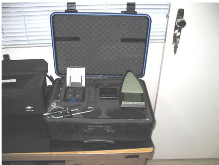
Figura 4.2 Analisador de Freqüência B&K 2260, Sonda de Intensimetria B&K 3595, Microfones B&K 4181, e protetor de vento.
