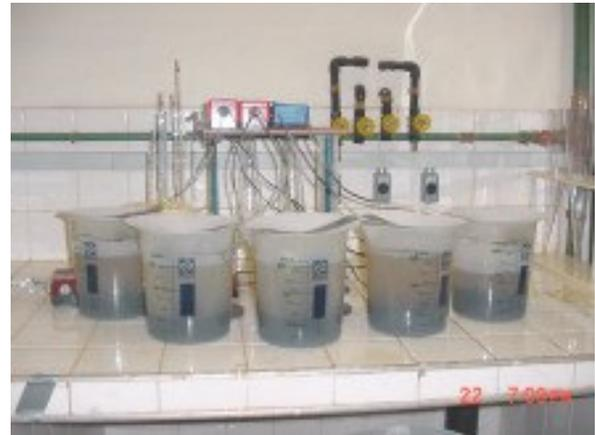
Figura 4.11: Aspecto dos reatores após o descarte de lodo e sedimentação.
