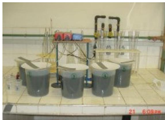
Figura 4.9: Bancada de reatores de Lodos Ativados por Batelada (LAB).
