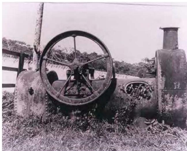
Figura 26 – Locomóvel (motor a vapor)
