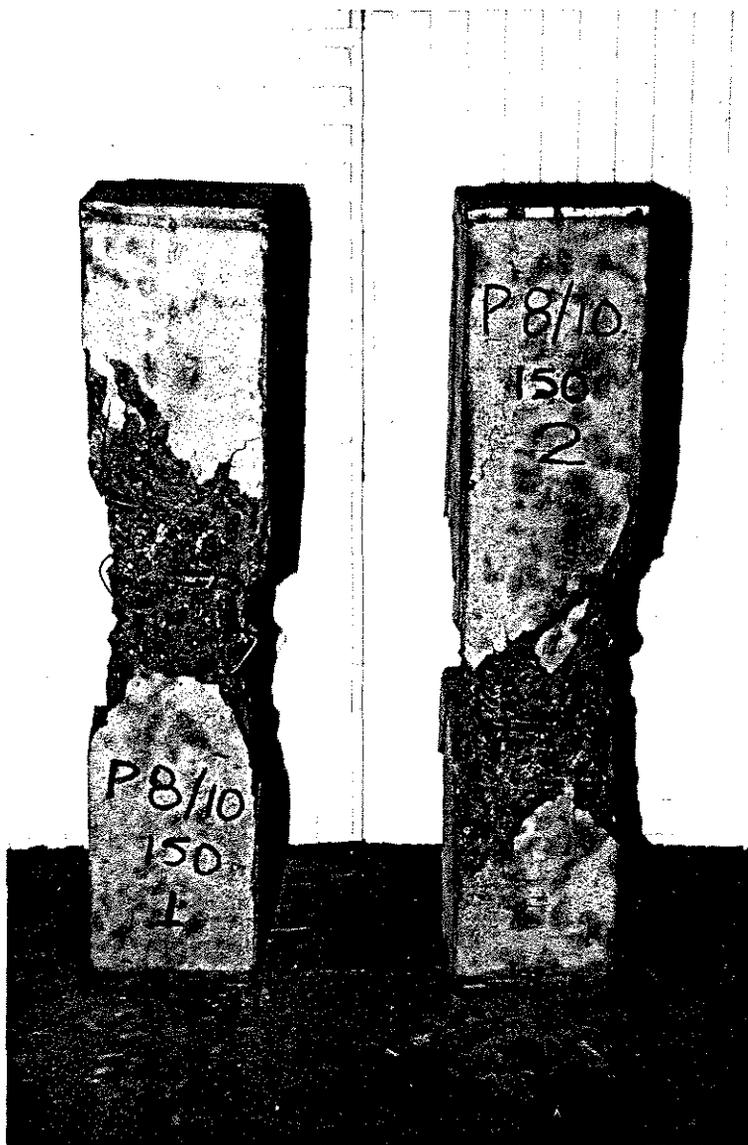
Fig. 17 - Pilares P8/10-150 ensaiados.
